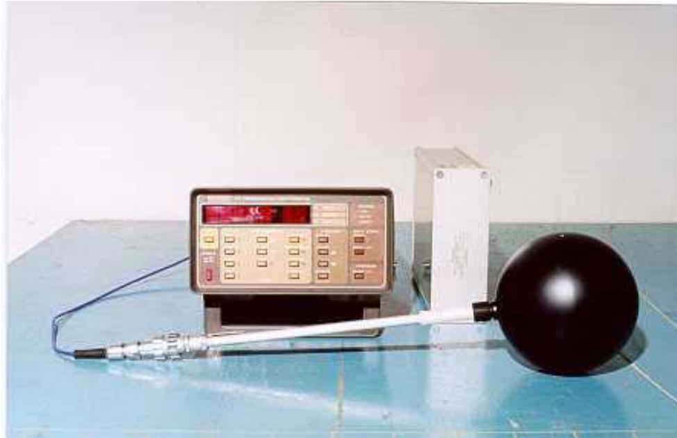
FIGURA 3.7 - Câmara de ionização PTW modelo LS01 e o eletrômetro
