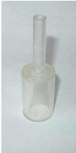
FIGURA 3.4 - Suporte plástico para posicionamento de fontes seladas dentro da câmara de ionização Capintec modelo CRC-7BT
