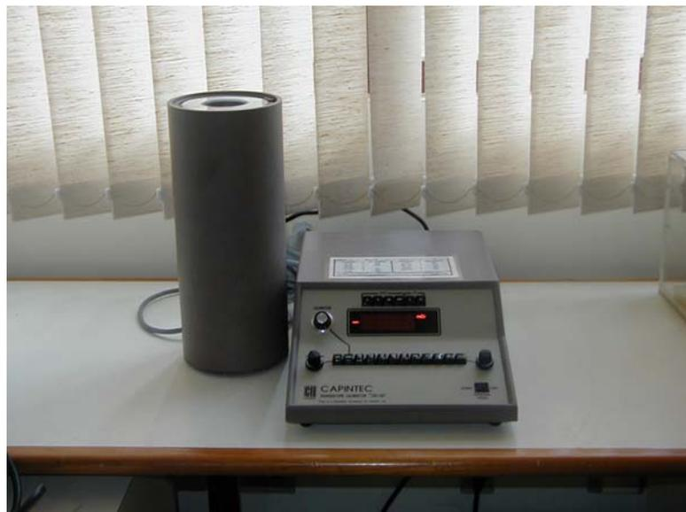
FIGURA 3.1 - Câmara de ionização tipo poço e o eletrômetro Capintec modelo CRC-7BT
