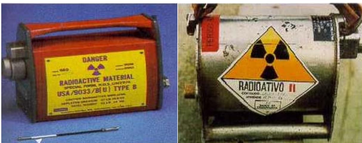
FIGURA 2.4 - Aparelhos para exames radiográficos industriais com fontes de  $^{192}\text{Ir}$
