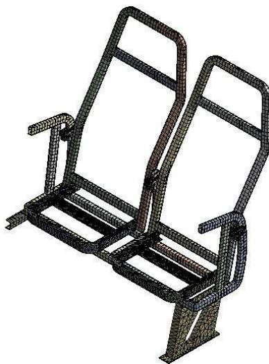
Figura 6.12 – Malha de elementos finitos estrutura poltrona
