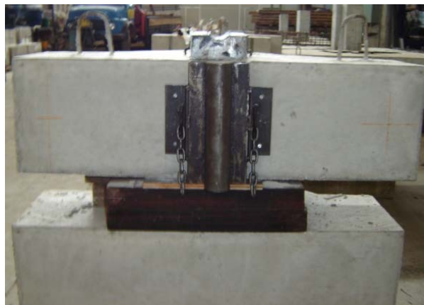
Figura 3.21 – Detalhe do aparelho de apoio
