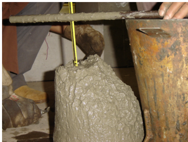
Figura 3.10 – Abatimento do concreto
