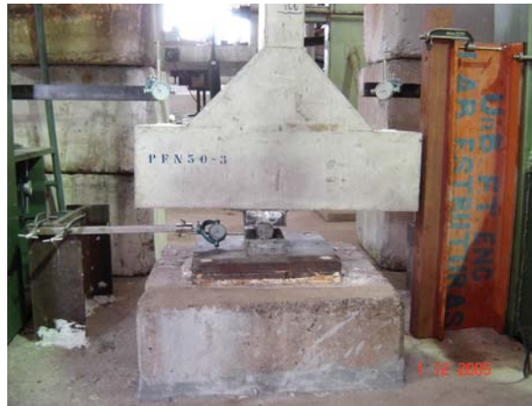
Figura 3.23 – Detalhe da base de apoio
