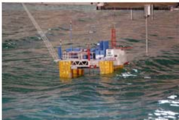
Figura 1-6 – Ensaio experimental com modelo da P-52. Ref.: Marintek (2002).
