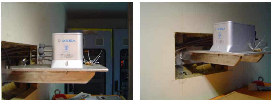
Figura 5-2 – Foto do equipamento OCTANS® que mede os movimentos da plataforma P-52.
