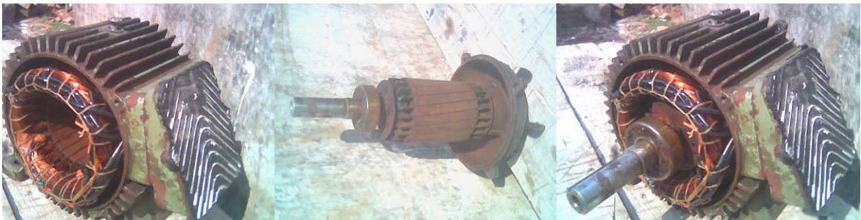
Figura 4.8 – Estator, rotor e motor assíncrono parcialmente integrado.
