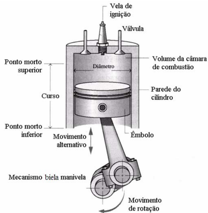
Figura 3.1– Esboço de conjunto êmbolo cilindro para motores alternativos de ignição por centelha. Fonte: Moran e Shapiro, 2002 (adaptado).
