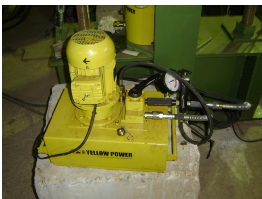
(c) – Bomba de aplicação das cargas P1.
