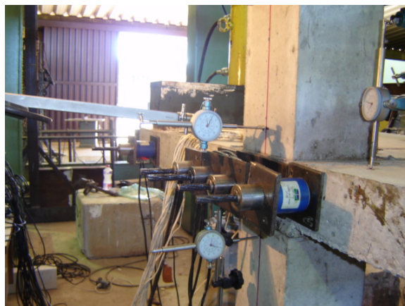
(e) – Defletômetros posicionados no pilar.
