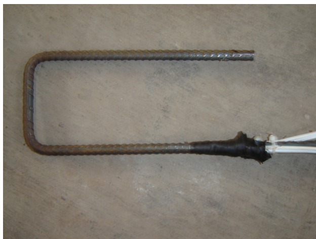
Figura 3.26 – Proteção final dos extensômetros com fita isolante.
