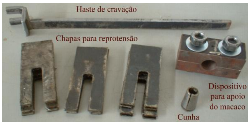
Figura 3.41 – Equipamentos empregados na etapa de protensão.
