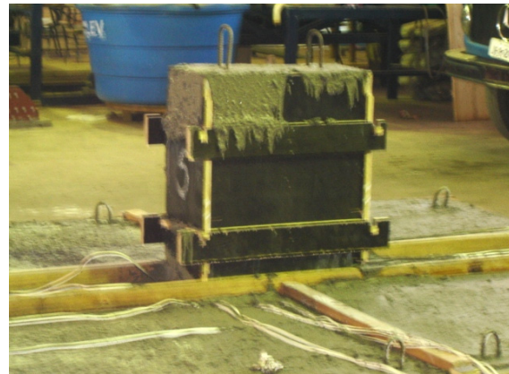
(b) – Pilares superiores concretados
