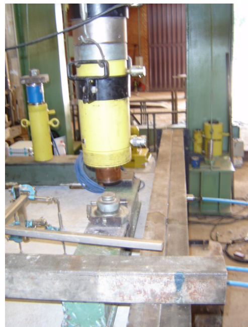
(b) – Macaco de aplicação da carga P2.
