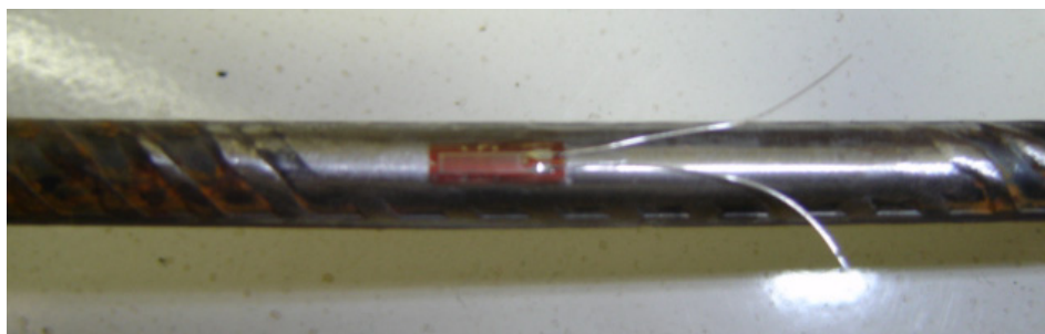
Figura 3.23 – Extensômetro colado em barra da armadura passiva.
