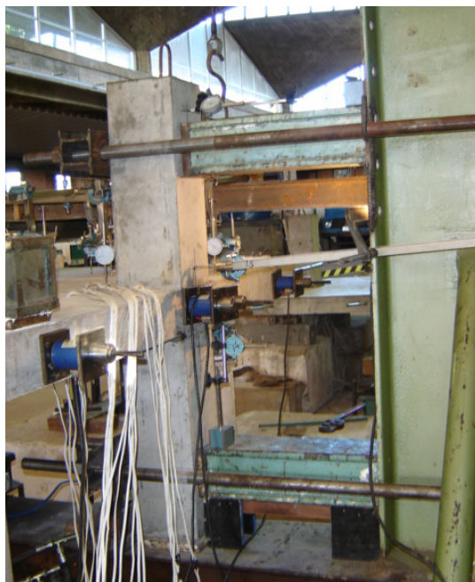
Figura 3.34 – Perfis e tirantes metálicos de reação horizontal no pilar.
