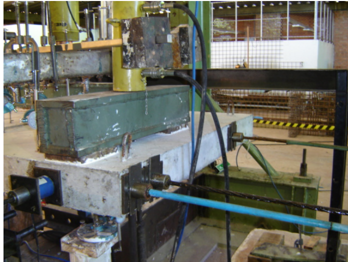
Figura 3.38 – Viga de distribuição da carga P1.
