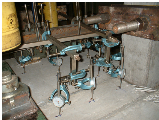
(c) – Defletômetros posicionados na face superior.
