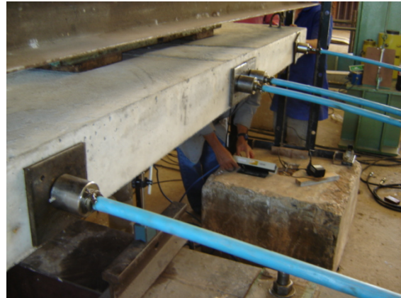
(b) – Detalhe da ancoragem ativa.
