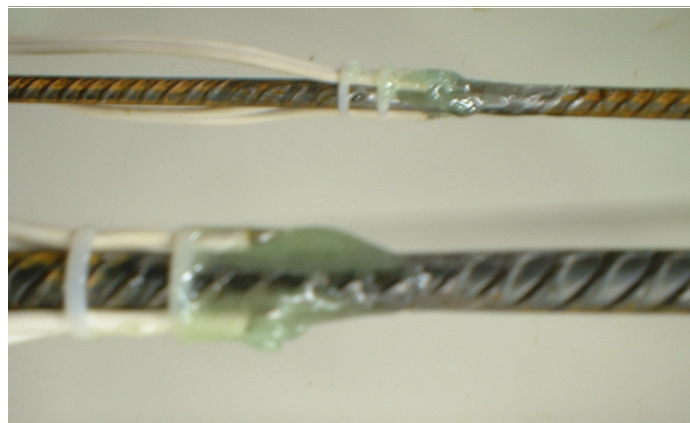
Figura 3.25 – Proteção mecânica dos extensômetros com silicone.
