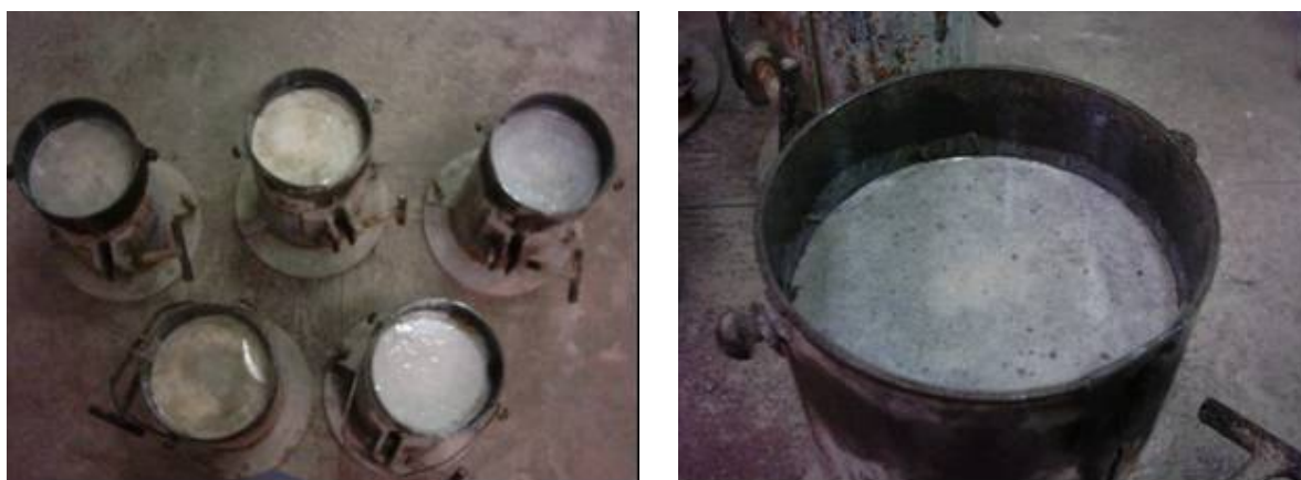
Figura 3.9. Formas utilizadas no ensaio de absorção capilar.
