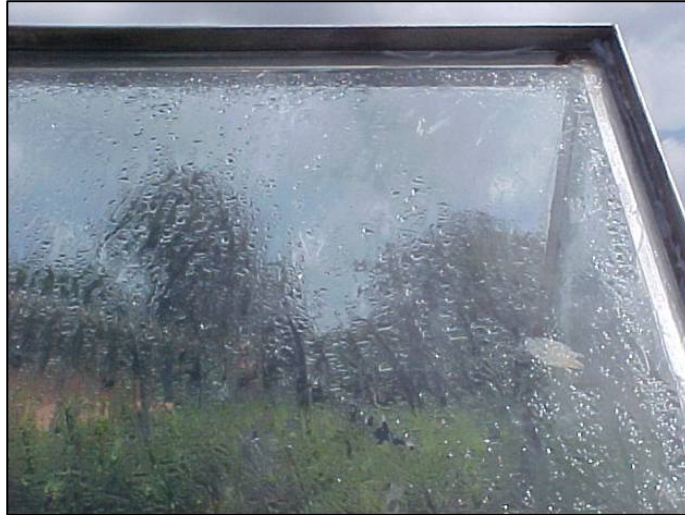
Figura 4.28: Gotas de água condensadas na cobertura do destilador
