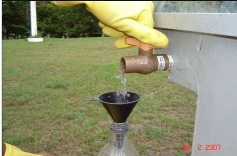
Figura 3.19: Coletas das amostras de água destilada das calhas de saída do sistema
