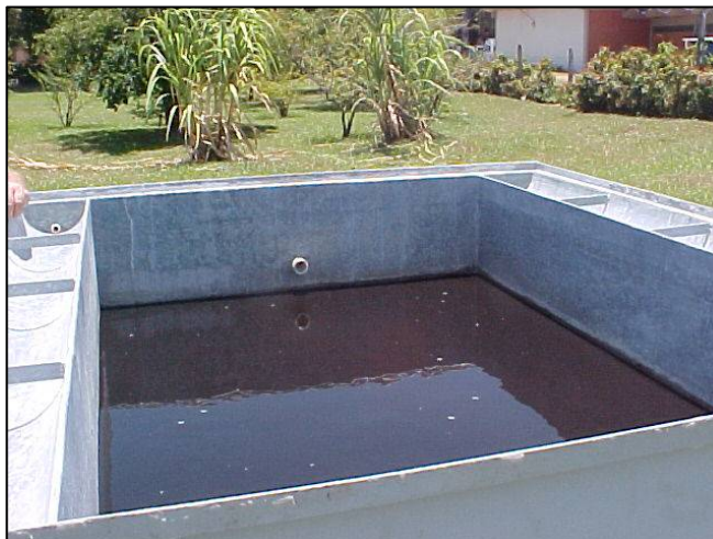
Figura 3.20: Evaporador preenchido com 45L de Lixiviado
