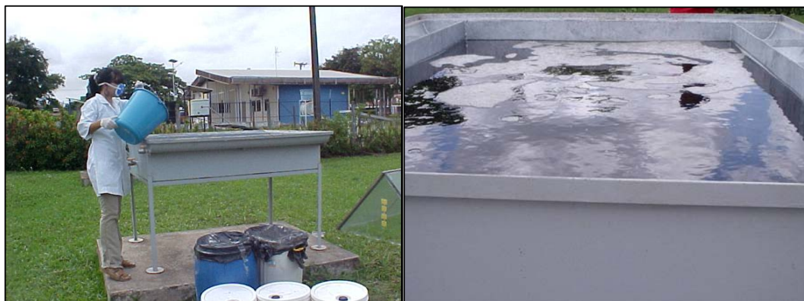
Figura 3.22: Enchimento do evaporador para o segundo experimento aberto.
