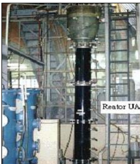
Figura 2. 4 - Reatores UASB em escala piloto Fonte: NASCIMENTO et al . (2000)
