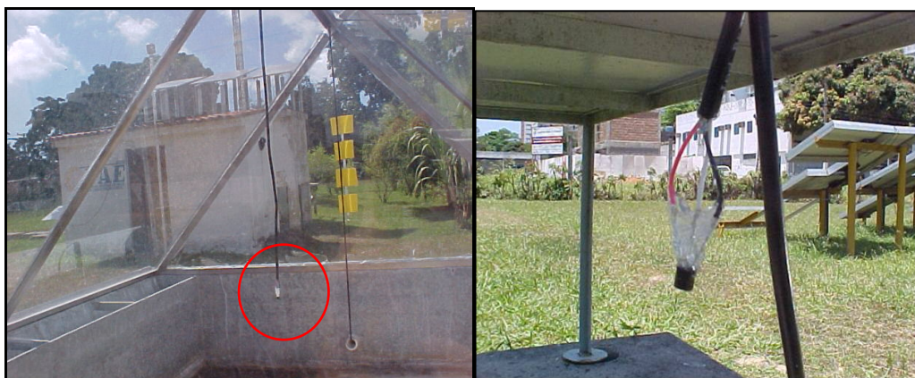
Figura 3.24: Medição da temperatura interna do Evaporador solar e temperatura ambiente através de um sensor
