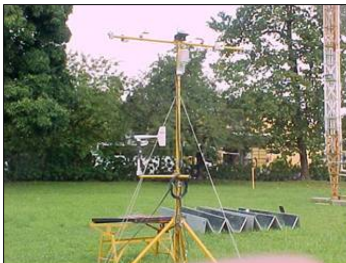
Figura 3.23: Equipamento de monitoração de Radiação solar
