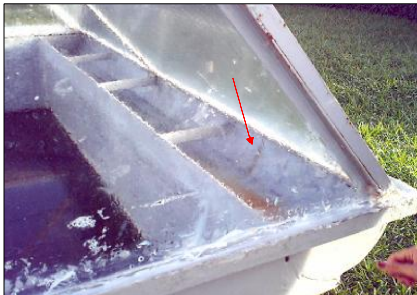
Figura 4.10: Ataque da ferrugem à cobertura de vidro do evaporador solar e contaminação do destilador
