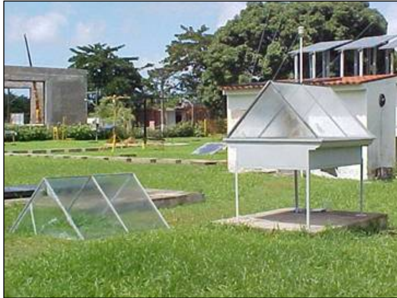
Figura 4.11: Nova cobertura de vidro para o Evaporador solar
