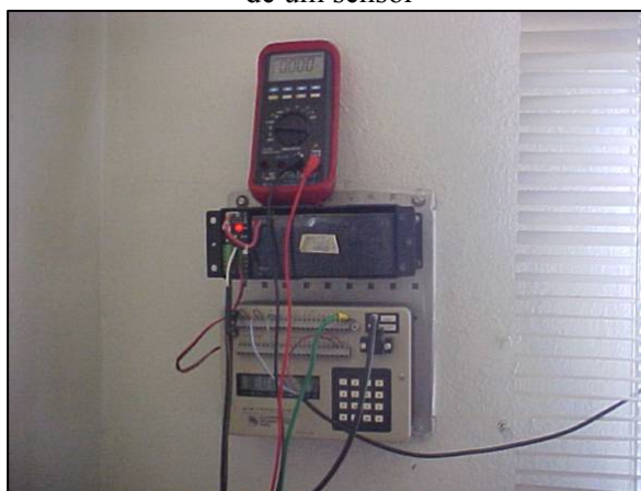
Figura 3.25: Aparelho que mede as temperaturas (DATALOG)
