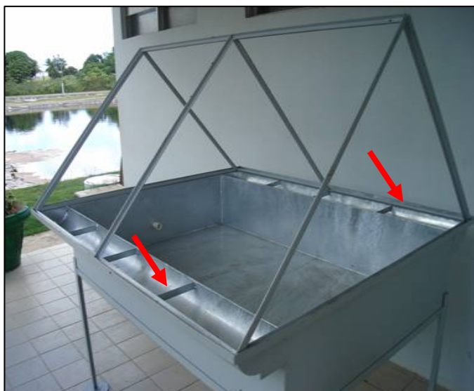
Figura 3.6: Vista das calhas onde é feita a coleta da água destilada
