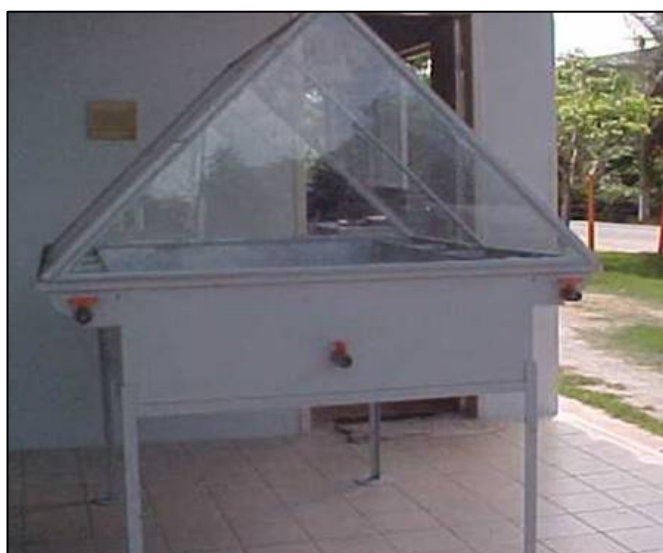
Figura 3.5: Visão frontal do destilador e dos dispositivos de coleta
