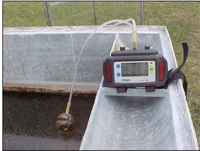
Figura 3.27: Equipamento para análise dos gases.
