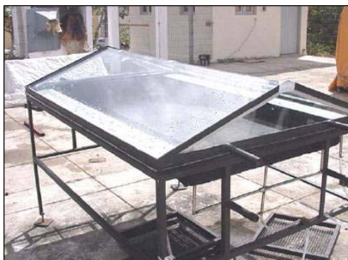
Figura 2.12: Destilador solar com cobertura de 20^\circ Fonte: Bezerra (2004)
