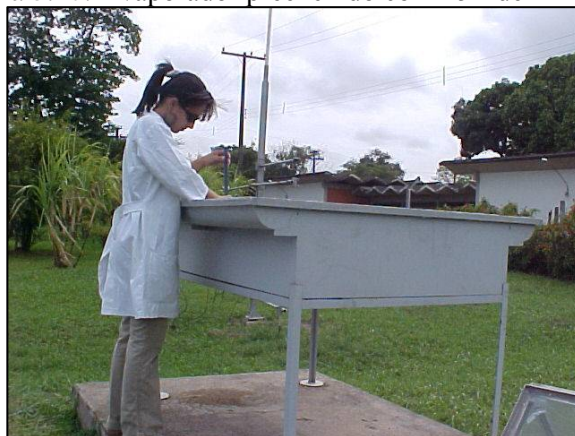
Figura 3.21: Medição diária da altura do livixiado através de um paquímetro
