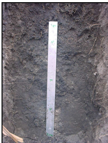
Figura 3.16 - Coleta com canaleta de alumínio e detalhe da bancada.
