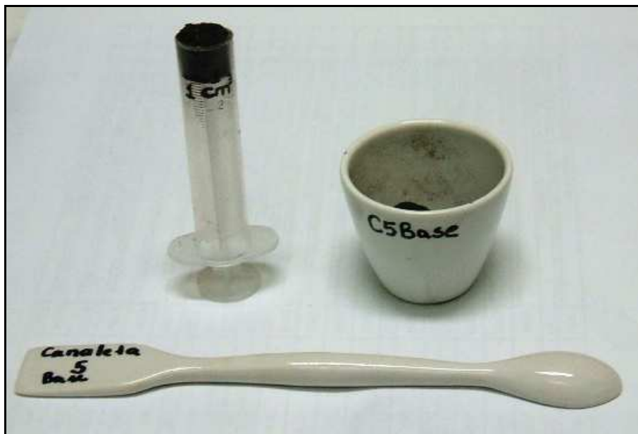
Figura 3.18 - Sub-amostragem dos sedimentos em 1\text{cm}^3 .
