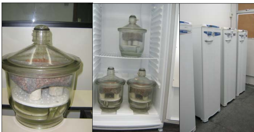
Figura 2. Amostras de amendoim acondicionadas sobre grade metálica no interior de dessecadores, contendo solução saturada de nitrato de potássio, dentro de câmara BOD
