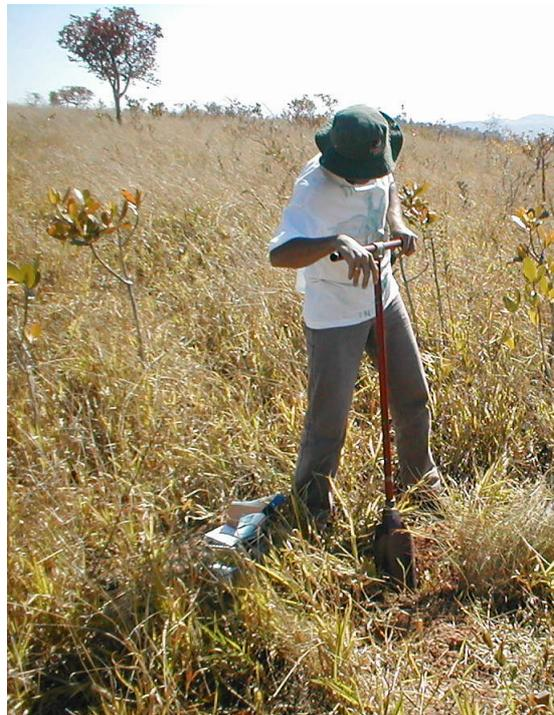
**Figura 4.15** – Coleta de amostras para determinação de cloreto.
