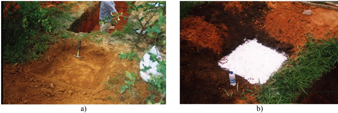
**Figura 4.14** – Ensaio de infiltração com NaCl, a) trincheira; b) sal distribuído depositado na trincheira.
