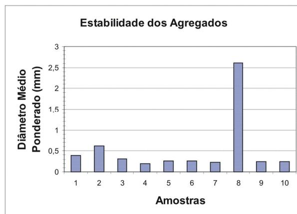
**Figura 2.10** - Diâmetros médios ponderados dos agregados, amostra 8 representa o horizonte B, e as demais o horizonte C.
