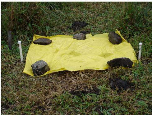
**Figura 4.10** – Ponto de injeção salina protegido contra os efeitos da evaporação.
