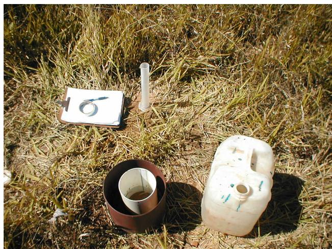
**Figura 4.5** – Infiltrômetro de anéis concêntricos.
