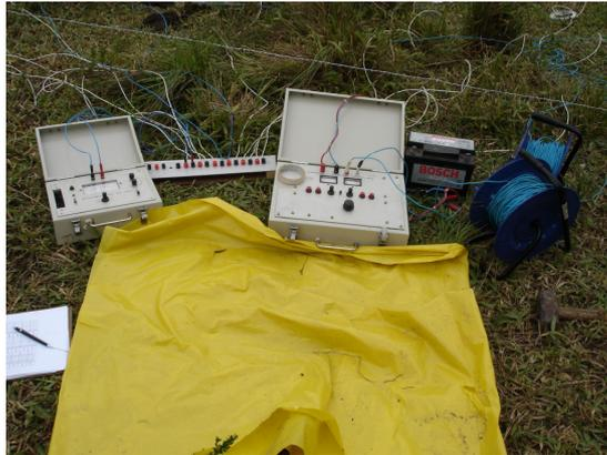
**Figura 4.6** – Eletrorresistivímetro utilizado na pesquisa.
