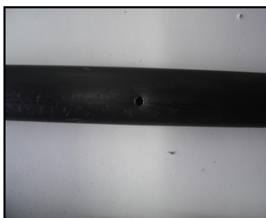
Figura 8 – Processo de perfuração dos tubos para a tomada de pressão
