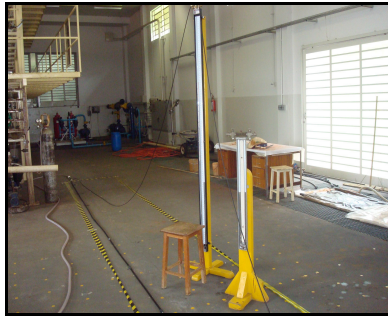
Figura 10 – Manômetro diferencial utilizado no experimento
