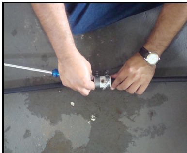
Figura 9 – Processo de colocação das tomadas de pressão para o manômetro
