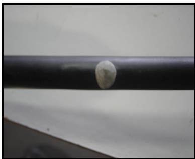
Figura 6 – Processo de vedação dos gotejadores
