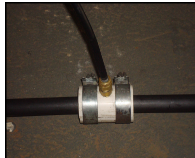
Figura 9 – Processo de colocação das tomadas de pressão para o manômetro
