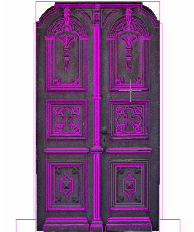
Figura 50 - Fotografia do detalhamento da porta principal e sobreposta sobre o levantamento e documentação gráfica minuciosamente detalhada pela equipe de arquitetos
