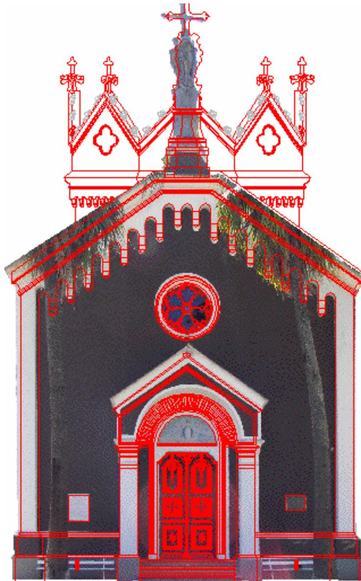
Figura 46 - Fotografia da fachada principal retificada e sobreposta sobre o levantamento e documentação gráfica realizada pela equipe de arquitetos em seu projeto de restauro (linhas em vermelho, para melhor observar o contraste sobre a foto).
