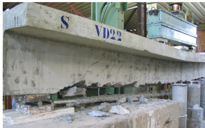
Figura 2.15 – Ruptura por destacamento do compósito (Castro, 2004)
