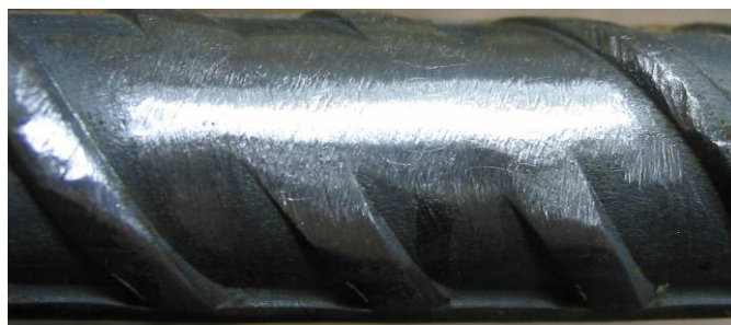
Figura 3.18 – Preparo da superfície do aço
