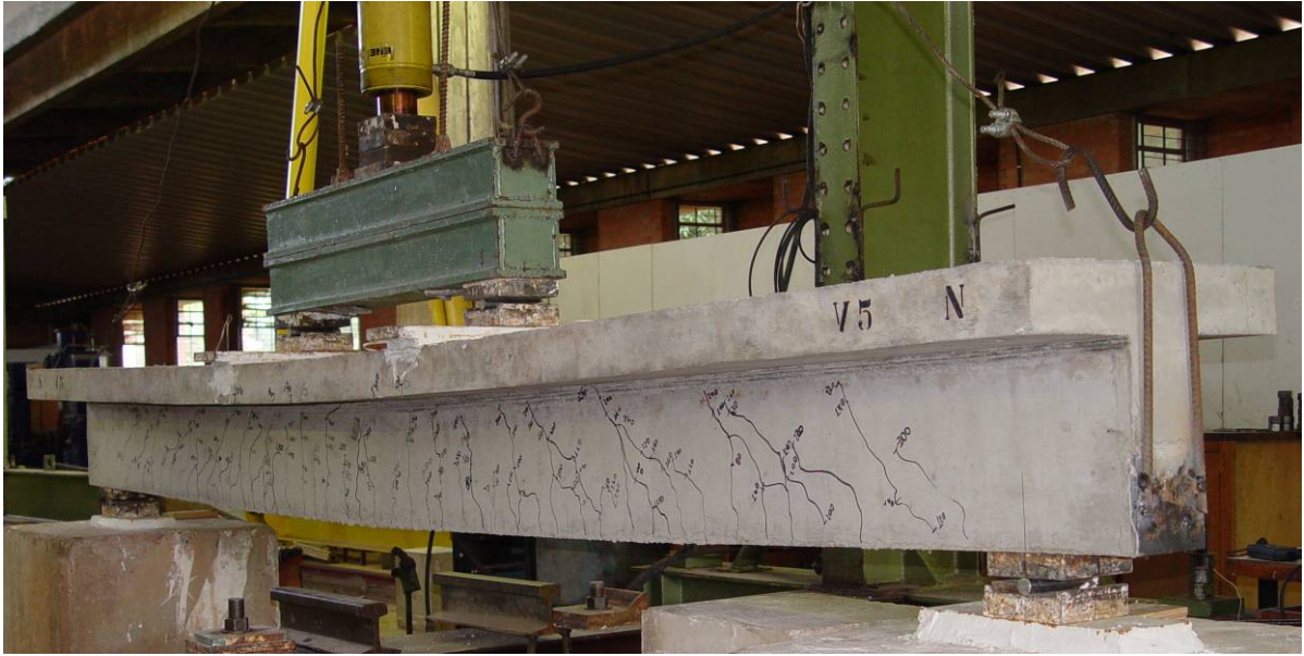
Figura 4.16 – Viga VB – REF após o ensaio
