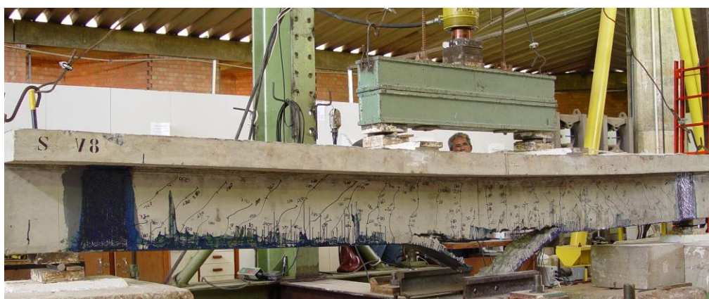
Figura 4.45 – Viga VB – RMC após o ensaio
