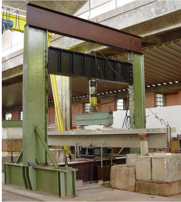
Figura 3.3 – Esquema de ensaio das vigas
