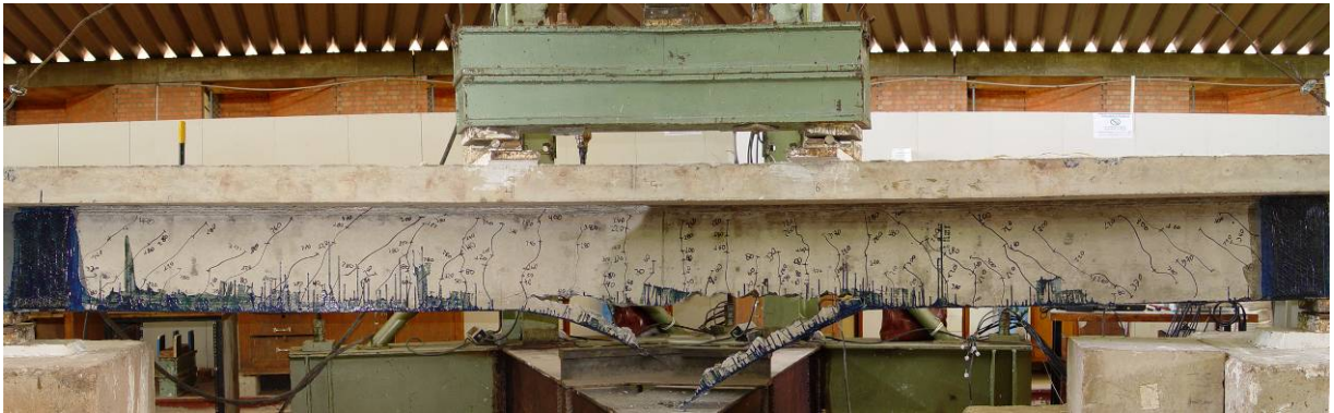
Figura 4.62 – Fissuração na viga VB – RMC, após o ensaio
