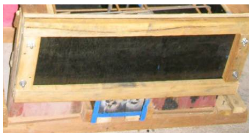
Figura 3.8 – Detalhe da chapa na forma
