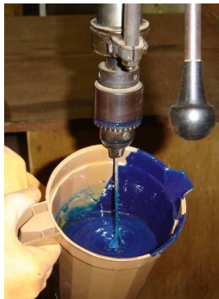
Figura 3.34 – Mistura dos componentes A e B da resina epóxi
