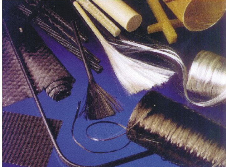
Figura 2.9 – Diversas formas das fibras utilizadas nos reforços (Chung, 2002)
