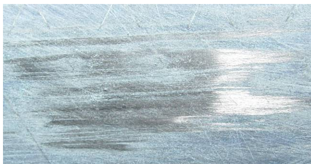
Figura 3.22 – Regularização da superfície da manta de CFRP
