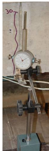
Figura 3.28 – Defletômetro montado na viga
