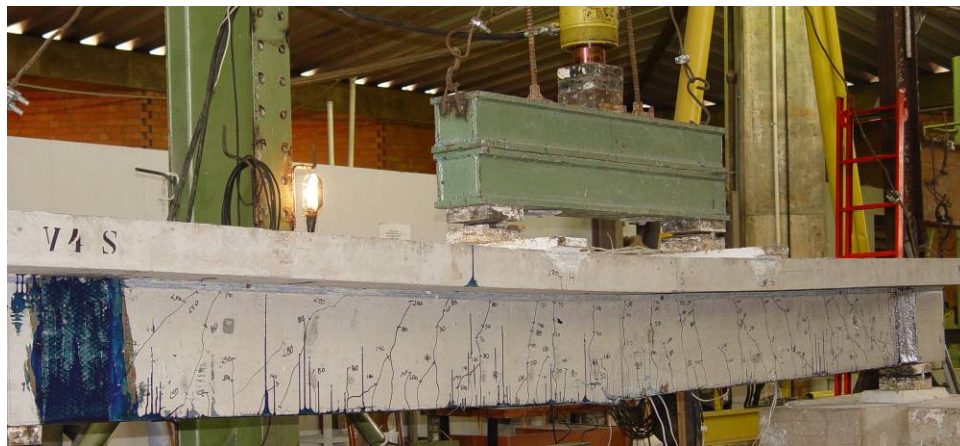
Figura 4.26 - Viga VA – RMC após o ensaio
