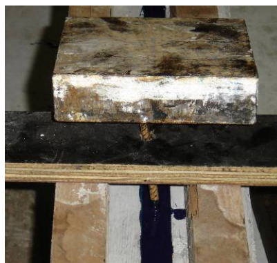
Figura 3.37 – Peso sobre a barra para evitar a barra emergir do entalhe
