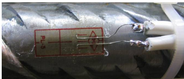
Figura 3.19 – Extensômetro colado no aço
