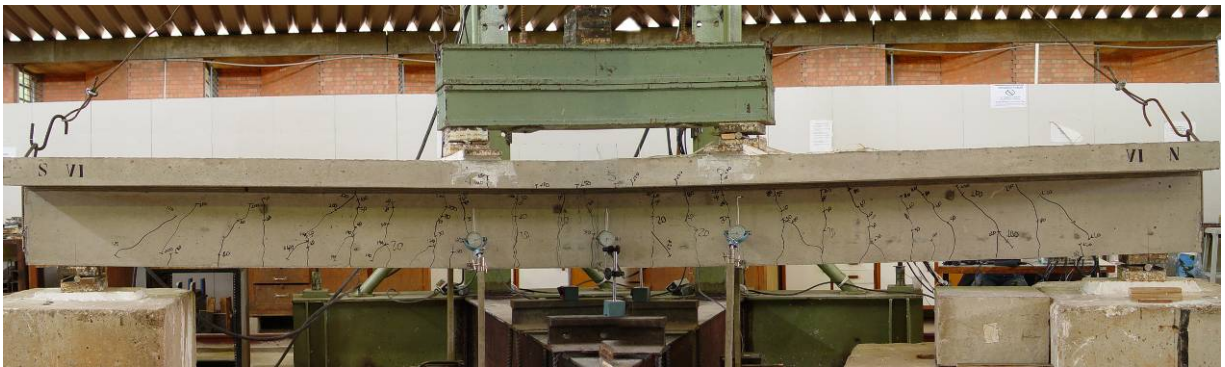
Figura 4.56 – Fissuração na viga VA – REF, após o ensaio
