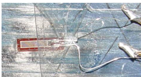
Figura 3.24 – Colagem do extensômetro no reforço com MFC
