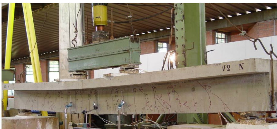
Figura 4.22 – Viga VA – RBC após o ensaio
