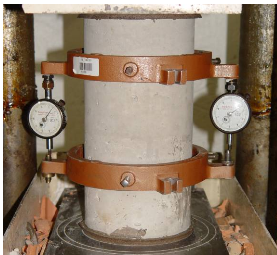
Figura 4.4 – Detalhe do ensaio de módulo de deformação secante do concreto
