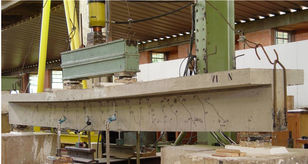
Figura 4.11 – Viga VA – REF após o ensaio
