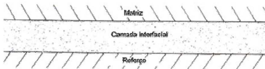
Figura 3.6 - Diagrama esquemático da camada interfacial formada pela interdifusão (HULL e CLYNE, 1996).
