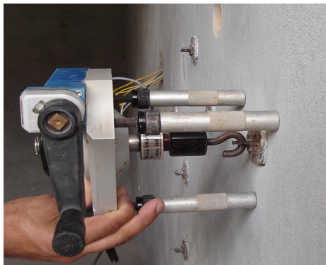
a) Vista do ensaio de aderência à tração.
