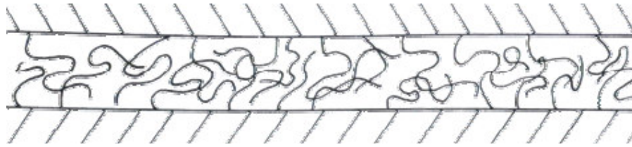
Figura 3.7 - Diagrama esquemático da aderência por interdifusão com polímeros (HULL e CLYNE, 1996).
