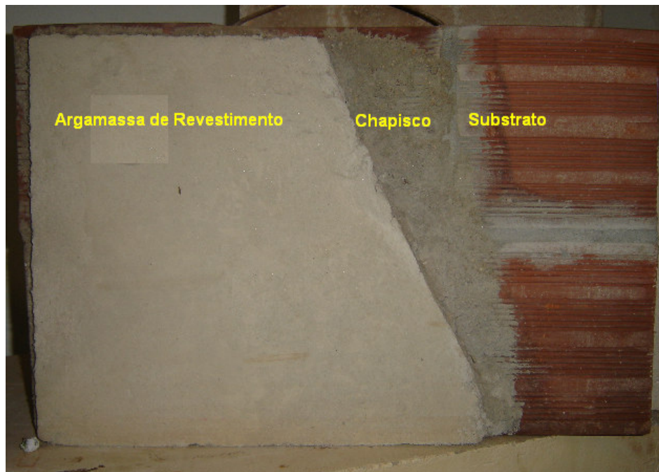
Figura 3.1 – Composição do sistema de revestimento em argamassa.
