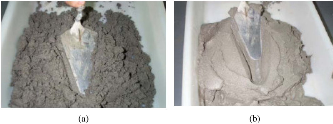
Foto 3.1 - Aspecto da mudança ocorrida nas características reológicas da argamassa com aditivo incorporador de ar: (a) Argamassa sem aditivo incorporador de ar com aspecto de “farofa” (b) Argamassa com aditivo incorporador de ar com aspecto de “mousse”. ALVES (2002).
