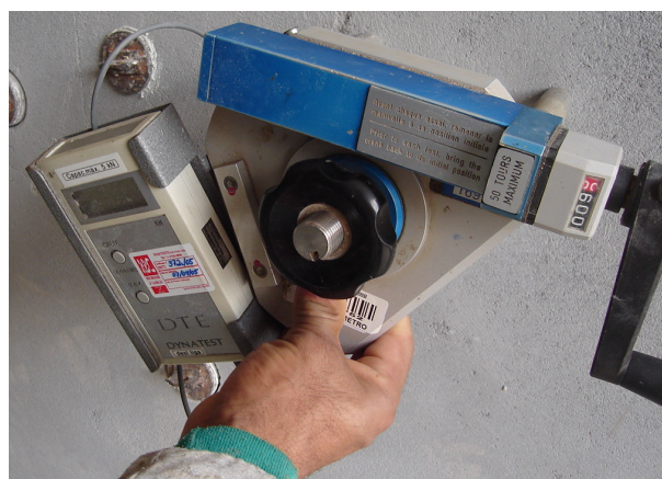
b) Vista frontal do dinamômetro utilizado.
