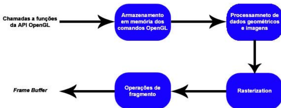
Figura 2.4 – Funcionamento do pipeline OpenGL .
