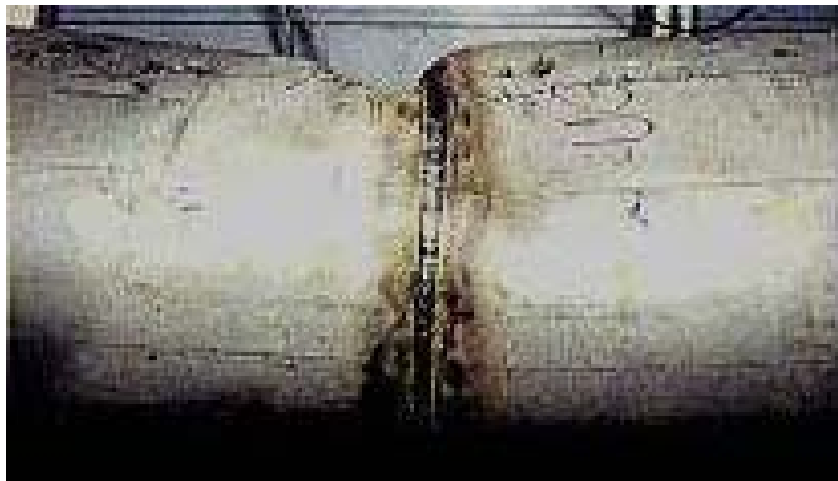
Figura 2.32 – Não pressurizada: modo diamond whinkle ( http://www.altapipe.ualberta.ca , Acesso 23 jan 2005)
