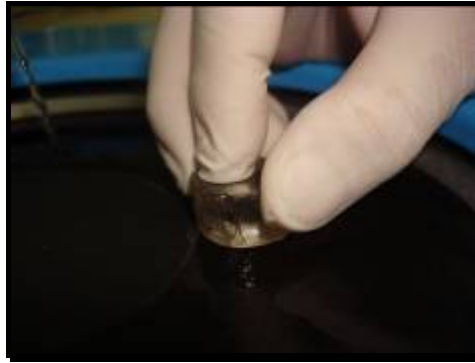
Figura 2 - Amostra durante fase de lixamento em politriz elétrica.
