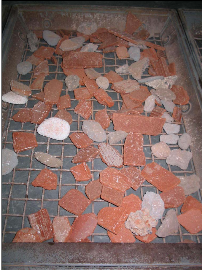
Fotografia 3.14 – Detalhe dos componentes retidos em uma das peneiras.
