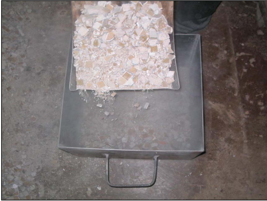
Fotografia 3.8 – Detalhe do lançamento e acomodação da amostra de RSCD dentro do recipiente paralelepípedo.
