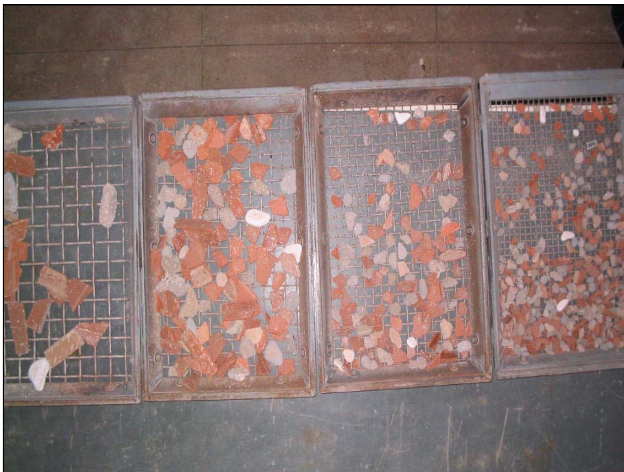
Fotografia 3.13 – Componentes retidos em peneiras de diferentes aberturas.
