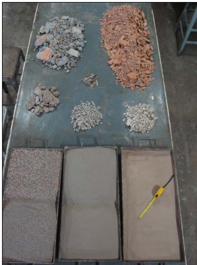
Fotografia 6.3 – Componentes da amostra de RSCD coletada em EC-4/CO-2.
