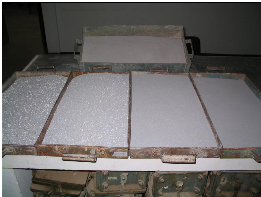
Fotografia 3.16 – Componentes do grupo “finos” separados em bandejas metálicas conforme a dimensão dos grãos.
