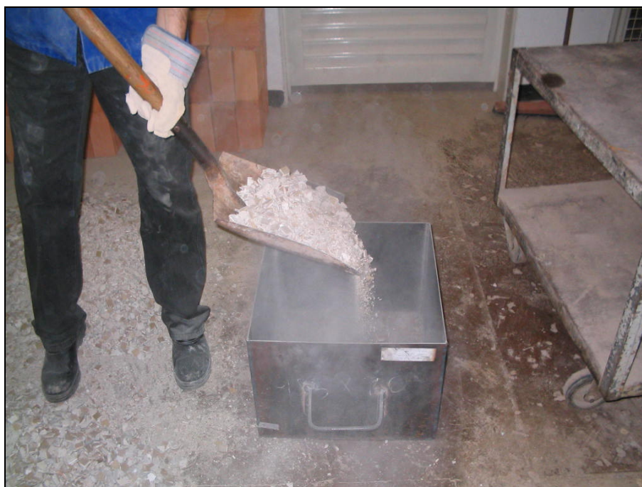
Fotografia 3.7 – Detalhe do lançamento da amostra de RSCD dentro do recipiente paralelepípedo.
