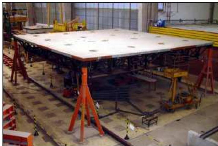
Figura 2.2. Reticulado espacial composto utilizado em análise dinâmica (Varela, 2004).
