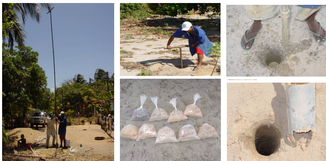
Figura 13 – Fotos do uso do trado manual, das amostras e do detalhe do poço.
