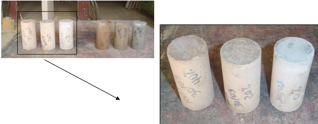
Figura 4.9: Corpos-de-Prova de argamassas contendo resíduo cerâmico curados à temperatura ambiente (grupo da direita na foto menor) e à 55 °C (grupo da esquerda na foto menor e detalhe à direita).
