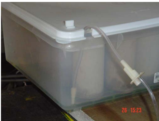
Figura 3.6: Controle do nível de água no ensaio de absorvidade.
