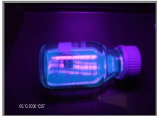
Figura 22 – resultado do método cromofluorogênico com presença de fluorescência indicando contaminação por Escherichia coli
