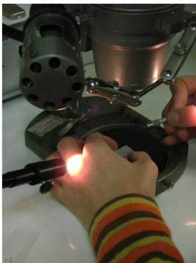
Ilustração 42 - Isolamento de material constituinte da policromia em microscópio estereoscópico. Foto da autora.
