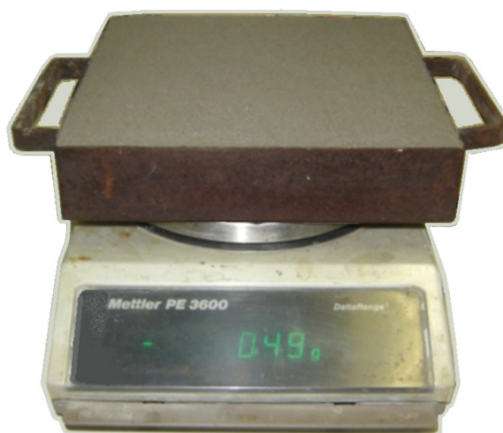
Figura 3.39 – Determinação da perda de massa da argamassa por evaporação.
