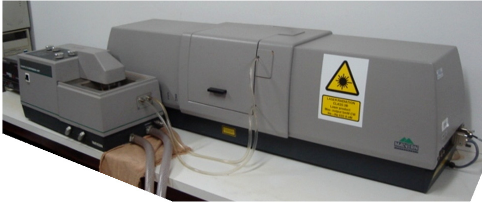
Figura 3.12 – Granulômetro a laser do Laboratório de Geotecnia da UnB.
