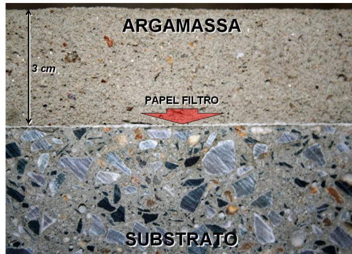
Figura 3.5 – Seção do corte do corpo-de-prova com papel filtro usado para o ensaio de retração do revestimento.
