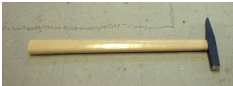
Figura 3.35 – Martelo usado para detectar de regiões de descolamento do revestimento.
