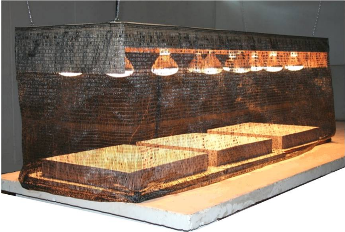
Figura 3.31 – Ensaio - condição de exposição severa.
