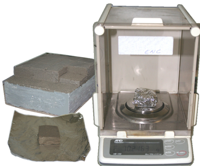
Figura 3.40 – Determinação da perda de massa da argamassa por absorção e evaporação.
