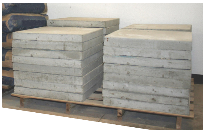
Figura 3.2 – Substratos de concreto, 50 cm por 50 cm, para o ensaio de retração do revestimento.
