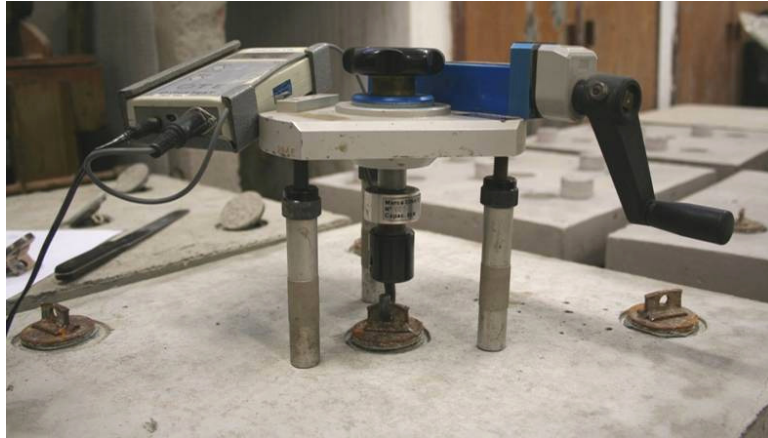
Figura 3.36 – Ensaio de determinação da resistência de aderência do revestimento.
