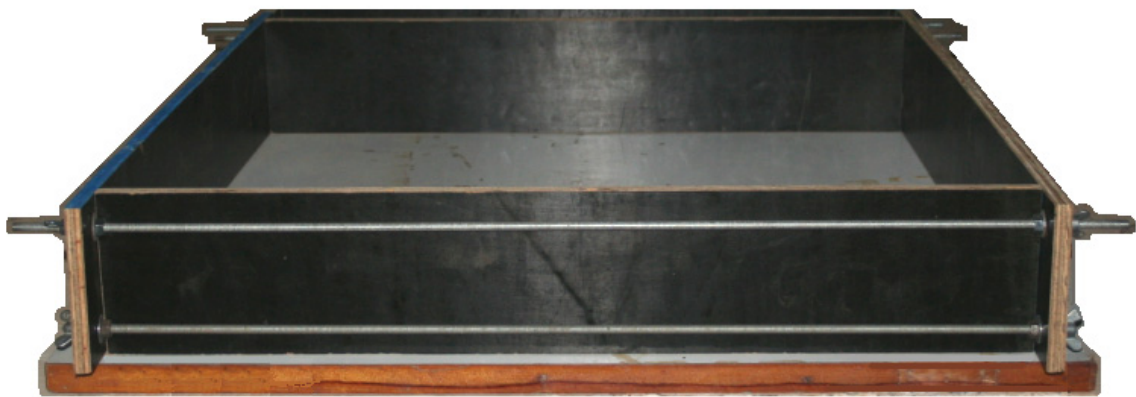
Figura 3.7 – Forma usada para a confecção dos corpo-de-prova de 50 cm por 50 cm com bordas revestidas para acompanhamento da retração na superfície do revestimento.
