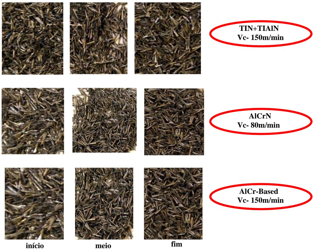
**Figura 5.12:** Análise da formação de cavacos nas condições de início e fim para os revestimentos ensaiados.
