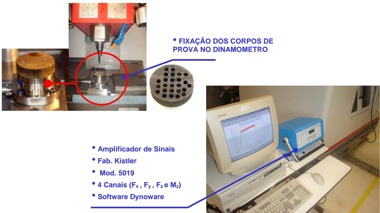
**Figura 4.6:** Sistema de aquisição de dados
