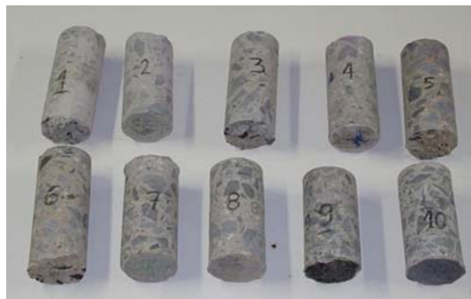
Figura 5.6 – Testemunhos extraídos da estrutura do Palácio da Justiça
