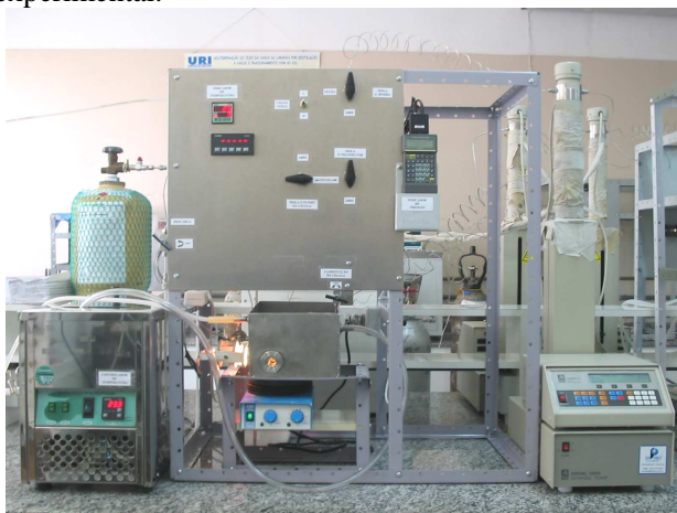
Figura 9: Foto da unidade de equilíbrio de fases. Fonte: (LANZA, 2004).
