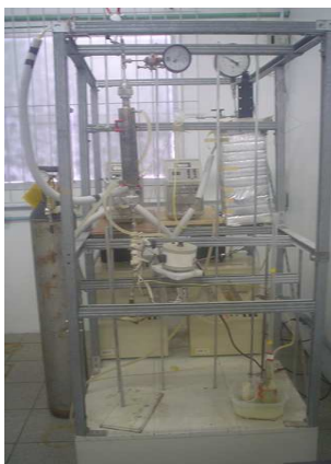
Figura 5: Foto da unidade de extração 1 (LATESC).
