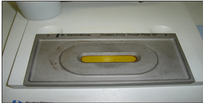
Figura 8 - Cristal de Selenito de Zinco, acessório do equipamento de ATR-FTIR, utilizado para leitura do estrato córneo das voluntárias.
