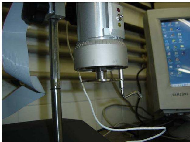
**Figura III.15 – Spindle Cônico preso ao Reômetro.**
