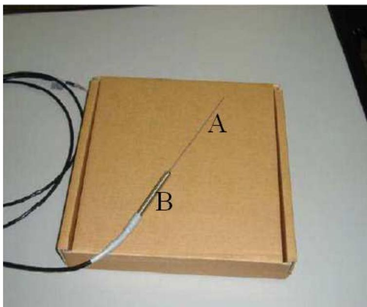
**Figura III.19 – Sonda Linear Hukseflux TP-02 do LTTC.** A – tubo (agulha) de aço-inoxidável com 150 mm de comprimento e 1,5 mm de diâmetro externo; B – base também de aço-inoxidável, com 50 mm de diâmetro e 10 mm de diâmetro externo.
