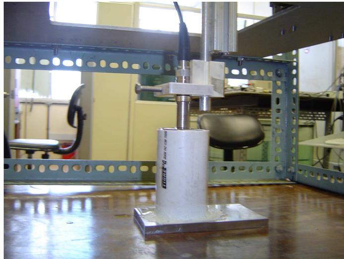
**Figura III.7 – Metodologia Experimental utilizada para a medição das propriedades acústicas (velocidade de propagação do ultra-som, coeficiente de atenuação e retroespalhamento) pela técnica de pulso-eco, podendo ser observado o material refletor de aço e a posição do transdutor em relação ao FMS, contido no início do cilindro de PVC.**
