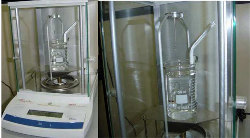
**Figura III.12 – Densímetro sendo utilizado no LTTC.**
