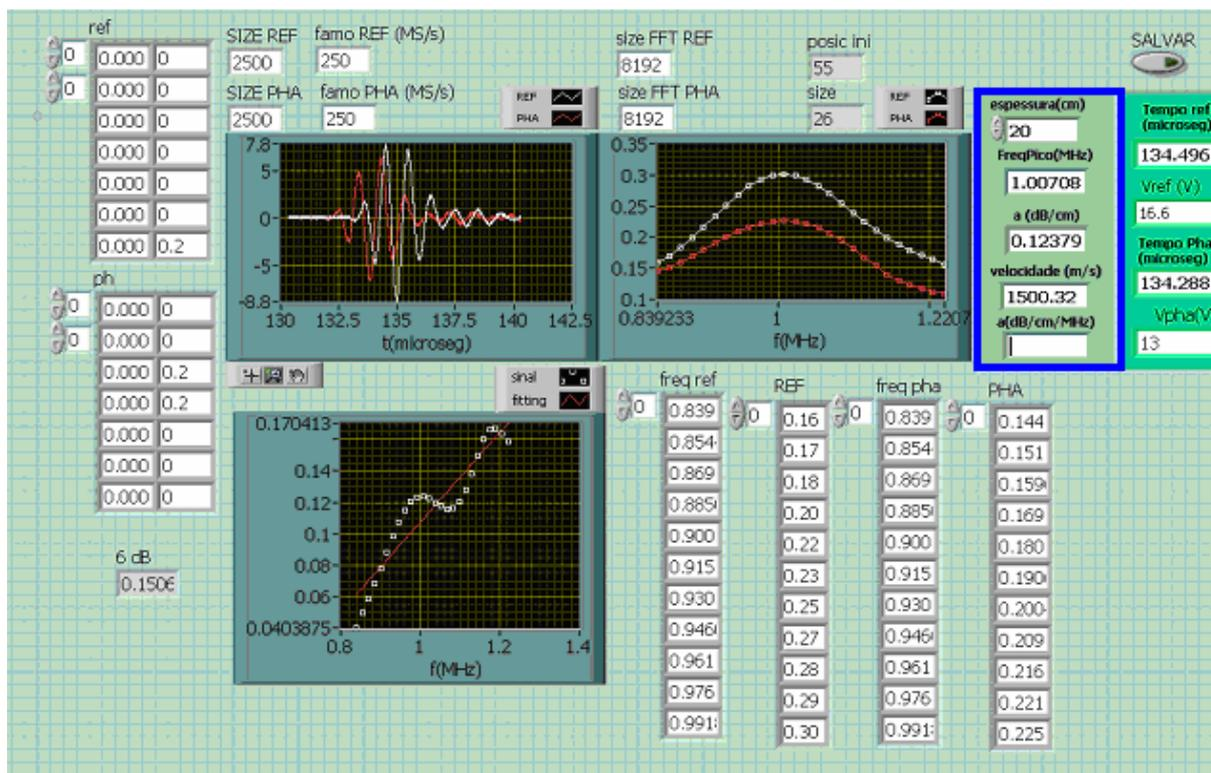
**Figura III.9 – Layout do software desenvolvido no Laboratório de Ultra-som, denominado *Acoustics Trans 2*, em LabView 8.2 para processamento das propriedades acústicas (velocidade de propagação do ultra-som e coeficiente de atenuação). No interior do quadro azul, de cima para baixo, os valores do coeficiente de atenuação, da velocidade de propagação e do coeficiente angular.**
