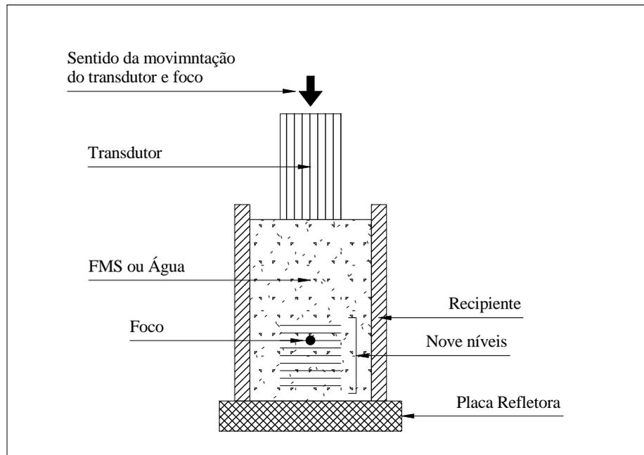
**Figura III.8 – Visão lateral da montagem experimental. A movimentação do transdutor segundo o eixo vertical se deu em nove passos de 0,5 mm de forma que o foco do transdutor se deslocasse verticalmente nas colunas de FMS ou da água na região anterior a placa refletora.**
