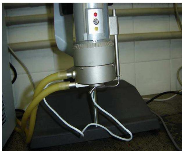
**Figura III.17 – A geometria cone-placa montada no reômetro.**
