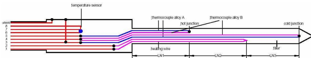
**Figura III.20 – Conexões da Sonda TP-02.**
