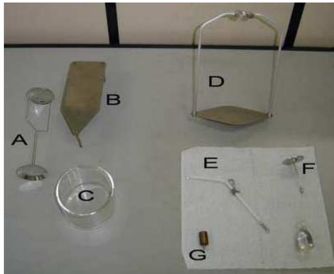
**Figura III.13 – Componentes do densímetro: A - suporte para amostra sólida; B - plataforma de metal para o suporte das peças do densímetro na balança; C - proveta, D - armação para fixação dos componentes do densímetro na balança; E – termômetro; F - prumo de vidro; G - uma peça adaptadora para montar tudo sobre a balança.**
