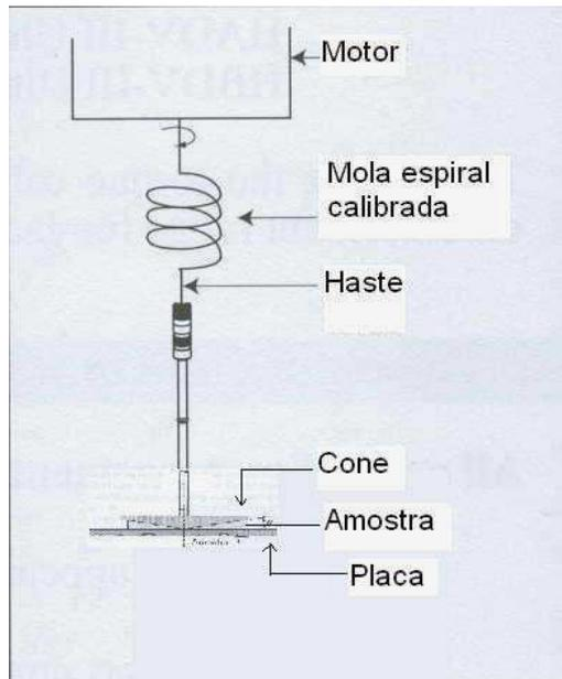
**Figura III.14 – Diagrama esquemático do funcionamento do Reômetro.**
