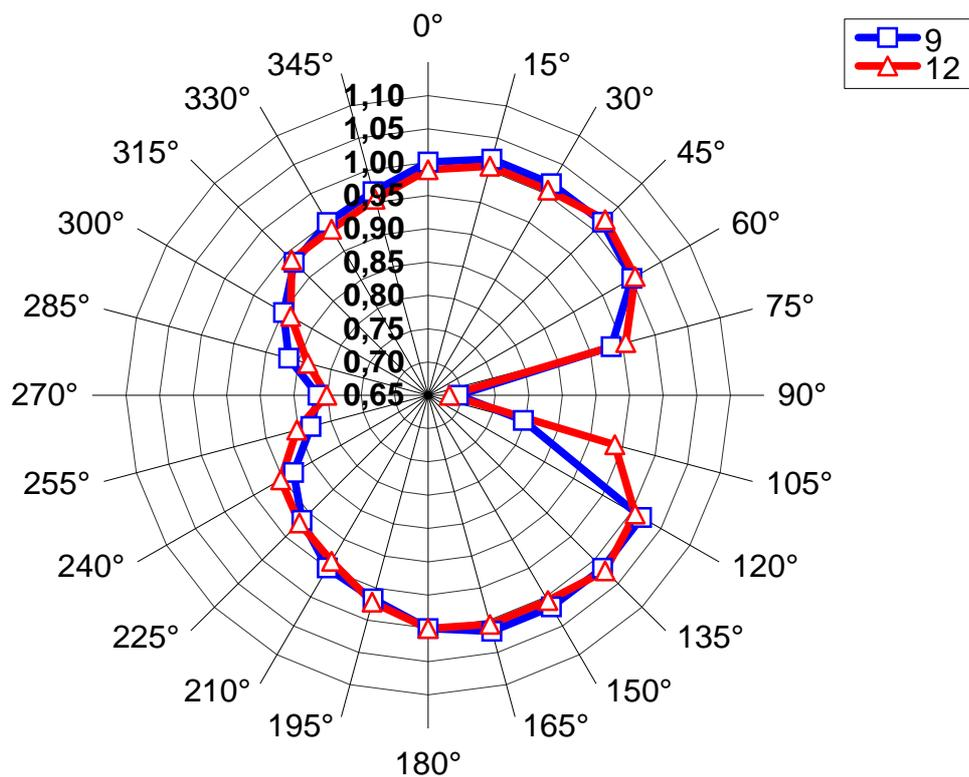
**Figura 4.19:** Dependência direcional transversal dos diodos Isorad-p (1-4MV).
