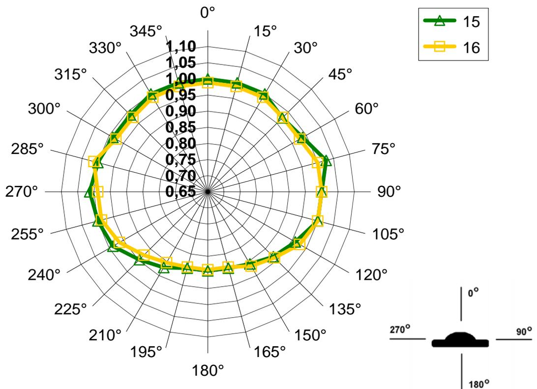
Figura 4.17: Dependência direcional axial dos diodos QED (6-12MV).
