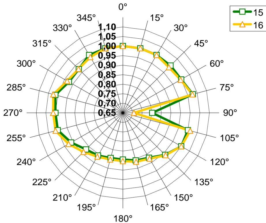
**Figura 4.20:** Dependência direcional transversal dos diodos QED (6-12MV).
