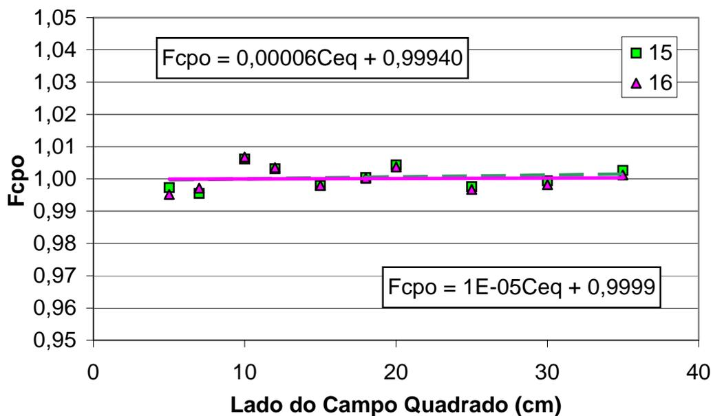
**Figura 4.10:** Fatores de correção do campo para diodos QED - Unidade Clinac600C.
