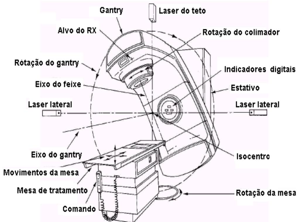
**Figura 3.16:** Principais características do acelerador linear [18].
