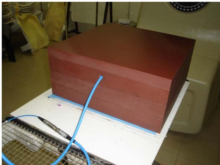
**Figura 3.19:** Câmara de ionização posicionada dentro do simulador de água sólida, na linha central, na profundidade de dose máxima ( $d_{máx}$ ).
