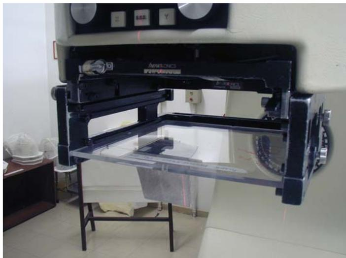
**Figura 3.20:** Bandeja lisa posicionada no colimador
