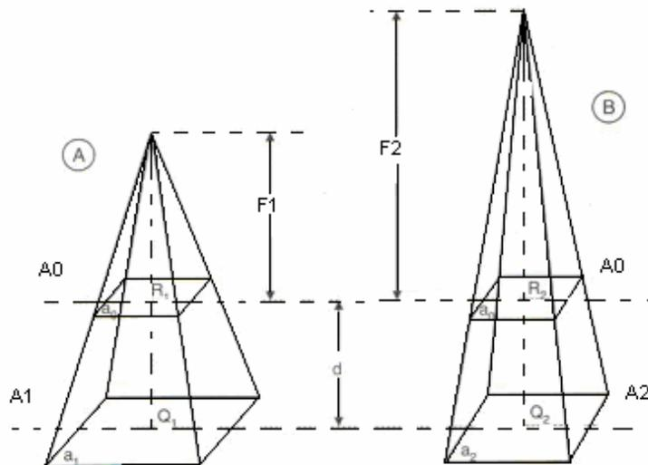
**Figura 2.9:** Esquema representando as duas distâncias de fonte superfície e a respectiva variação do volume irradiado [9].
