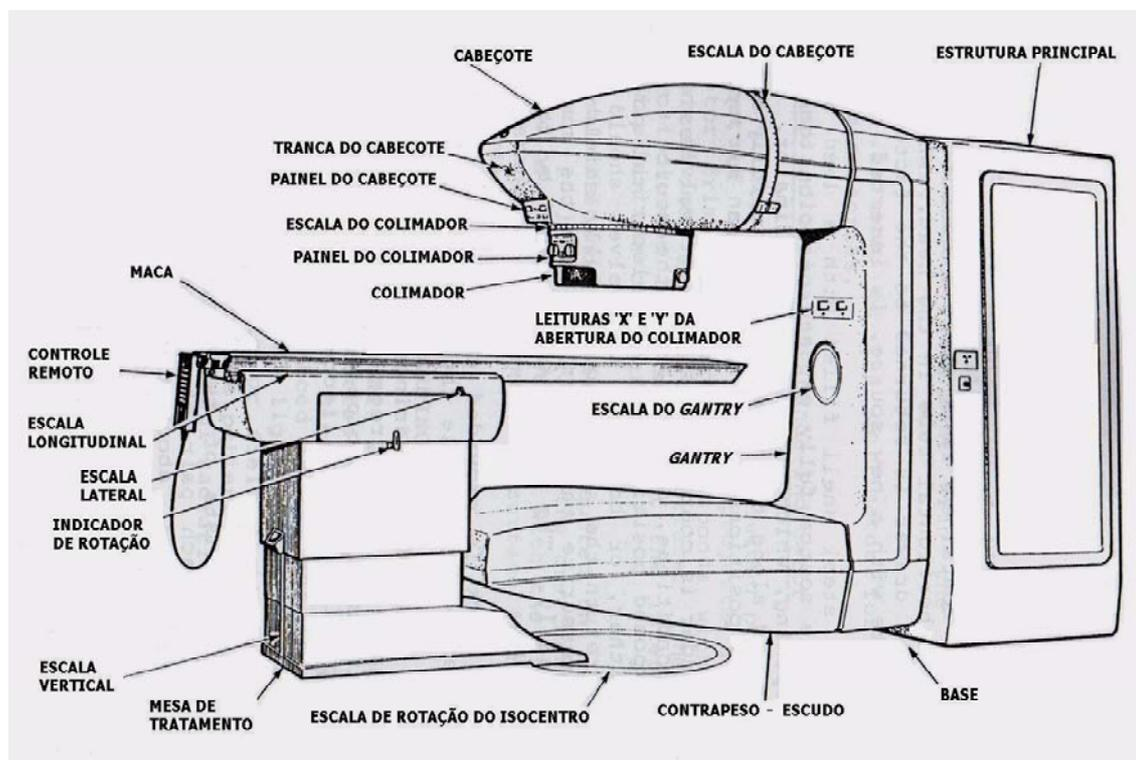
**Figura 3.14:** Componentes do Irradiador Theratron 780X [30].
