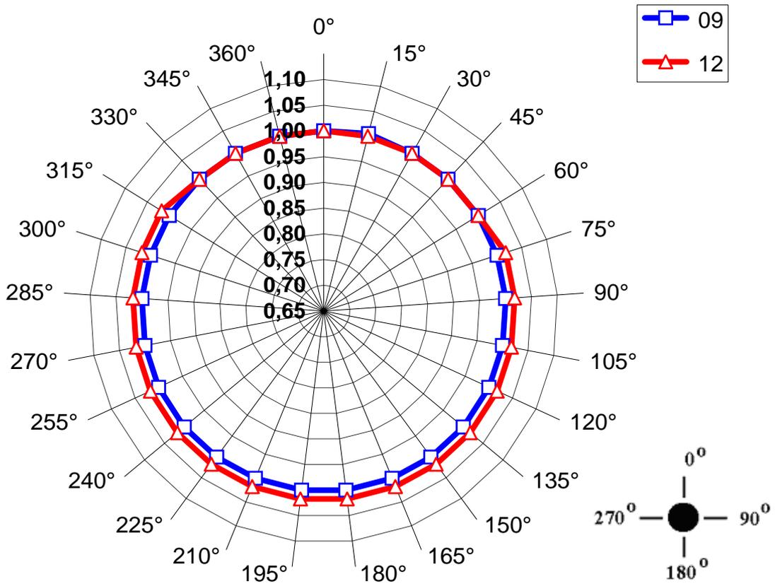
Figura 4.16: Dependência direcional axial dos diodos Isorad-p (1-4MV).
