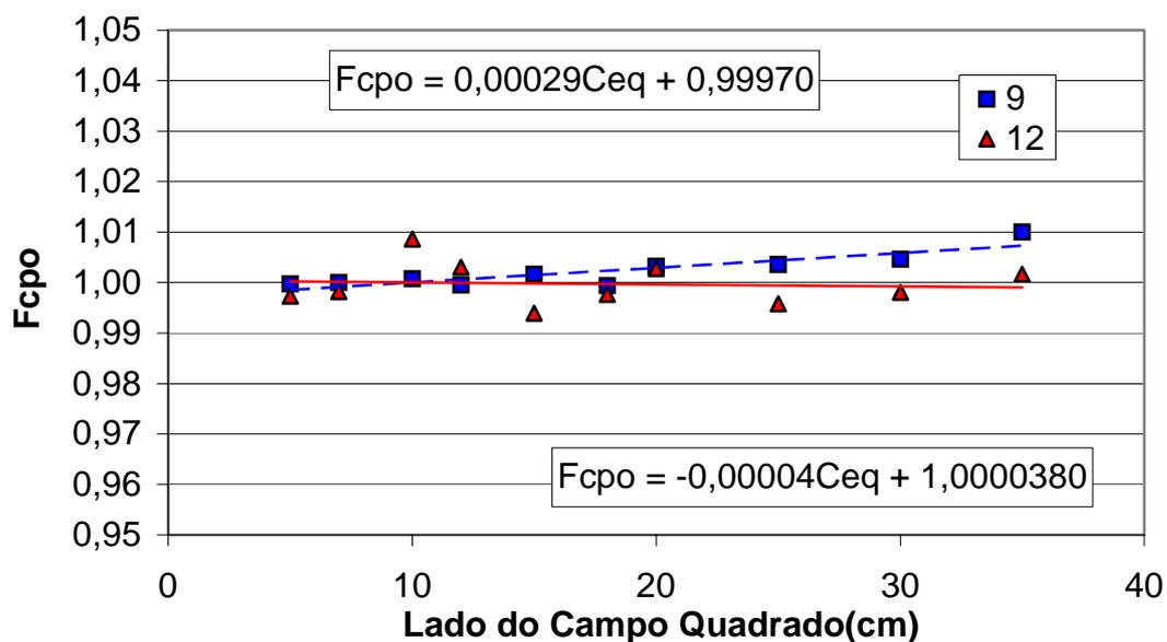
**Figura 4.9:** Fatores de correção do campo para diodos Isorad-p - Unidade  $^{60}\text{Co}$  Theratron 780X.
