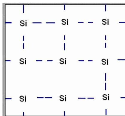
**Figura 2.3:** Rede ou Estrutura Cristalina do Semicondutor de Silício – Estrutura Intrínseca de Si [17].
