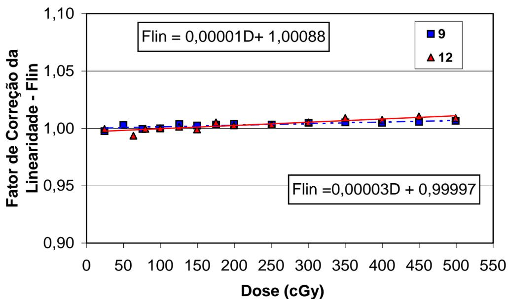
**Figura 4.7:** Fatores de correção da linearidade dos diodos Isorad-p - Unidade  $^{60}\text{Co}$  Theratron 780X.
