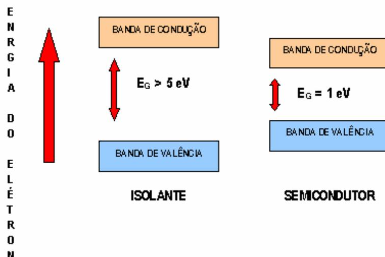
**Figura 2.2:** Estrutura de bandas de um semicondutor ( $E_G$ = energia de *Gap*) [10].
