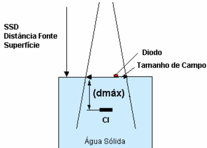
**Figura 3.18:** Arranjo experimental para a calibração dos diodos[7].
