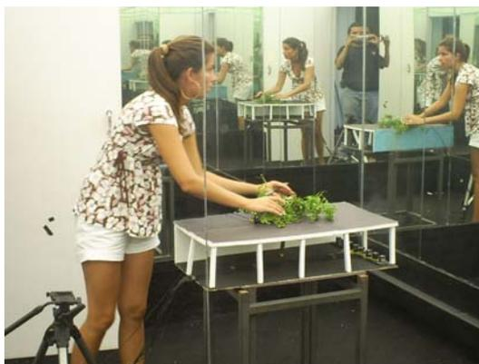
**Figura 54.** Céu Artificial de Caixa de Espelhos do LabCon-Arq-UFSC.
