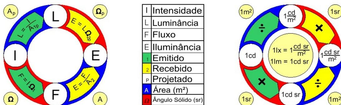
**Figura 4.** Relações entre as grandezas fotométricas (Fonte: Syntlight Fundamentals, 2004).
