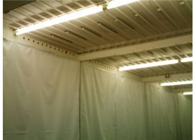
Figura 79. Lâmpadas de reforço ao sistema de geração de iluminação do céu artificial.
