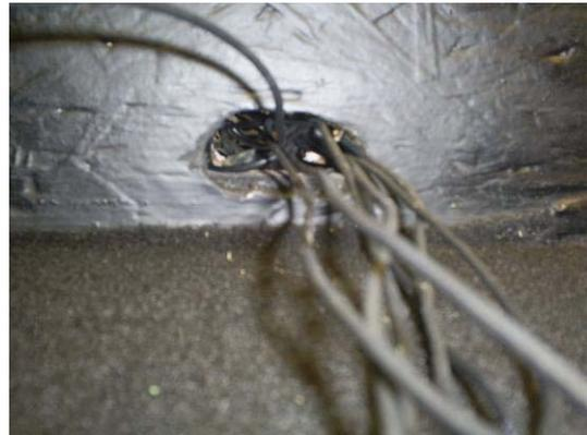
**Figura 73.** Fios das fotocélulas saindo do céu por um dos furos, para conexão com um *data logger*.
