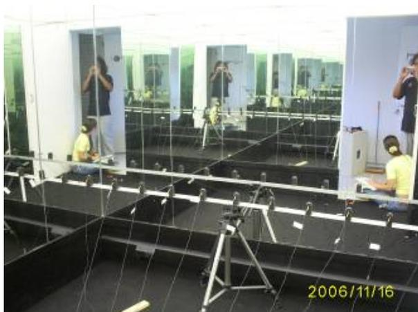
**Figura 63.** Estrutura de suporte para mapeamento de iluminâncias.
