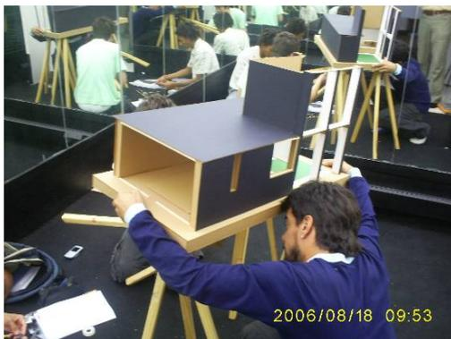
**Figura I.18.** Instalação e nivelção dos modelos no céu artificial.
