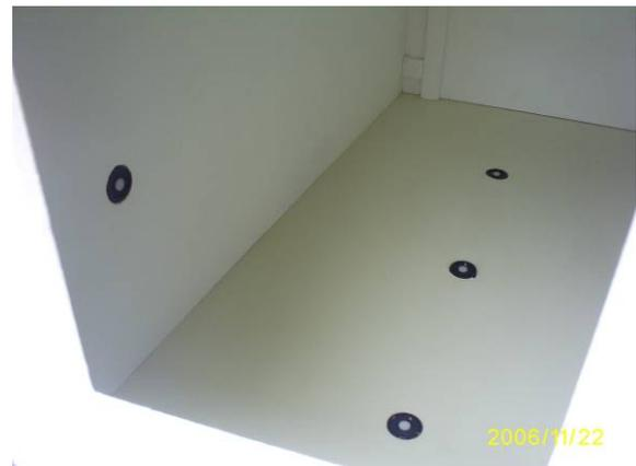
**Figura 99.** Posição das fotocélulas no piso do modelo arquitetônico seguindo o eixo da janela.
