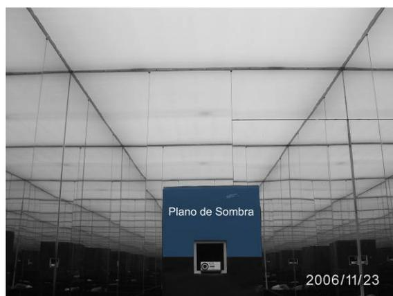
**Figura 109.** Efeitos do acabamento preto de um modelo arquitetônico no interior do céu artificial.
