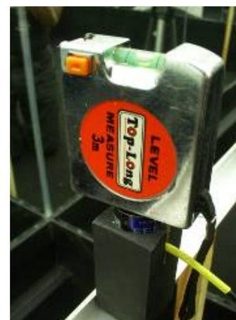
**Figura 64.** Nivelção das fotocélulas.
