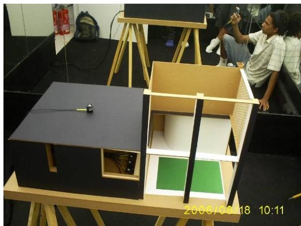
**Figura I.4.** Avaliação quantitativa de iluminação com modelo arquitetônico no céu artificial do LabCon.
