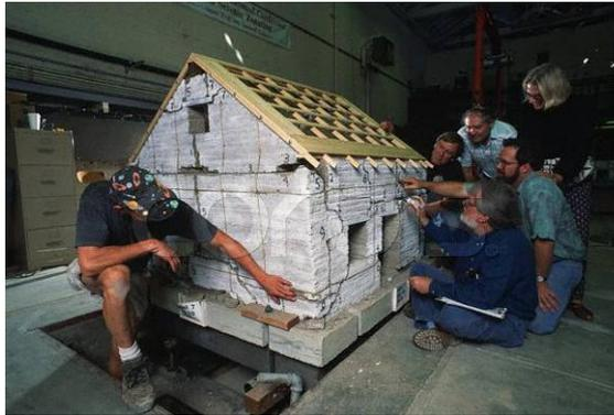
**Figura 17.** Prova sísmica de segurança num modelo de escala de uma casa de adobe (Fonte: [www.corbis.com/Rogger](http://www.corbis.com/Rogger) Resmeyer. Stanford University, Palo Alto, Califórnia. USA)
