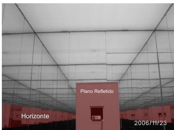
**Figura 108.** Efeitos do acabamento branco de um modelo arquitetônico no interior do céu artificial.
