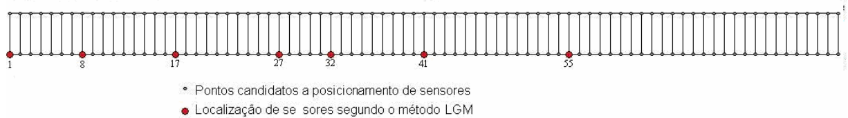
Figura 7. 33 – Localização dos sensores segundo o método LGM considerando eixo de simetria – Modos verticais – Tabuleiro da ponte pênsil de Clifton.
