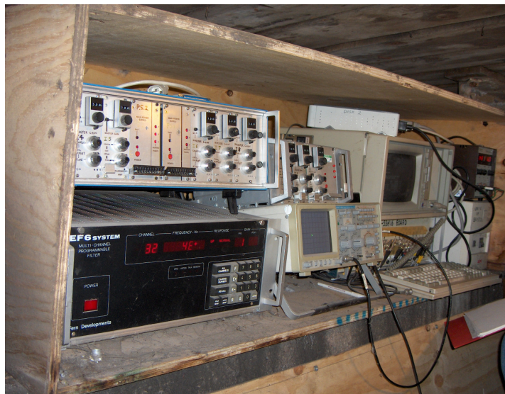
Figura 7. 42 - Equipamentos utilizados para aquisição dos sinais provenientes dos acelerômetros.
