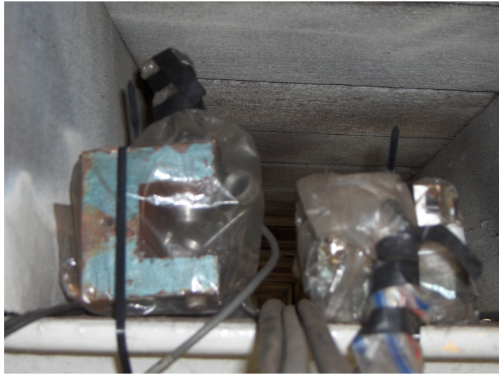
Figura 7. 41 – Servo acelerometro utilizado no ensaio da ponte de Clifton.
