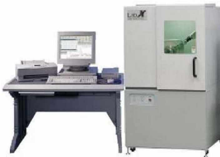
Figura III.3: Difratorômetro XRD-6000- Unidade principal e sistema de processamento de dados.
