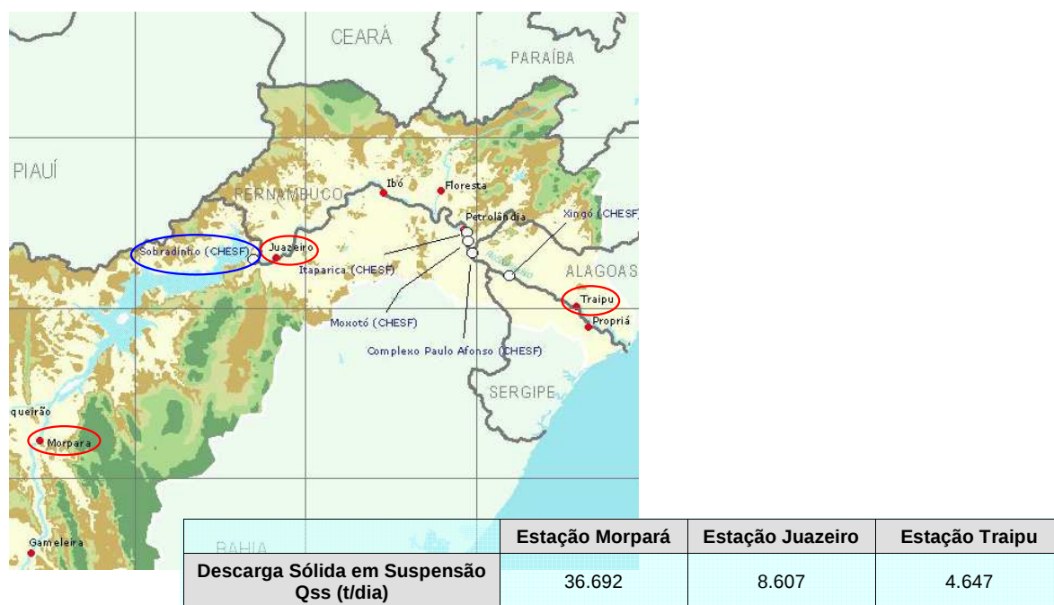
Figura 14: Descarga Sólida em suspensão (t/dia) nas estações fluviométricas a montante e a jusante do reservatório de Sobradinho. (ANA/GEF/PNUMA/OEA, 2003; LIMA et al , 2001)
