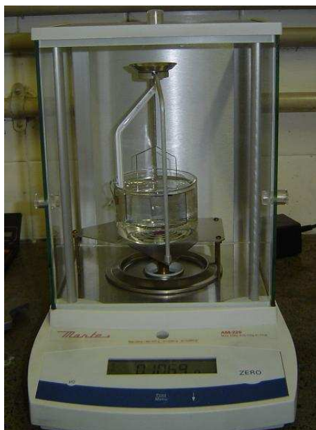
Figura IV.9 – Balança AM220 da Marte e dentro desta está montado o Densímetro Sartorius YDK 01.
