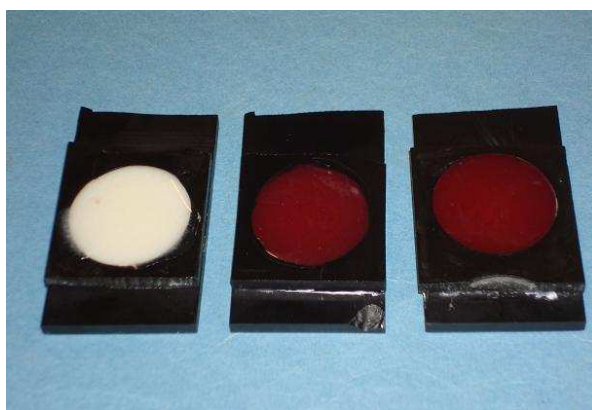
Figura IV.19: Amostras confeccionadas em moldes de acrílico. Estes moldes serão os posicionadores a serem utilizados no acessório de reflectância difusa. Foram confeccionadas quatro amostras: uma como amostra-padrão e três com os materiais termocromáticos.
