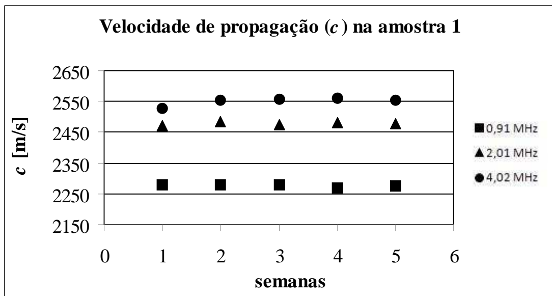
Figura V.6 – Valores de média de velocidade de propagação da amostra 1 nas cinco semanas de medições, nas frequências de 0,91, 2,01 e 4,02 MHz.
