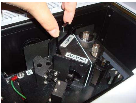
Figura IV.20 – Local de colocação dos posicionadores no espectrofotômetro na posição amostra. Há uma incidência de radiação UV-visível na faixa de comprimento de onda determinada e é feito o espectro do percentual de intensidade de radiação refletida (%R).
