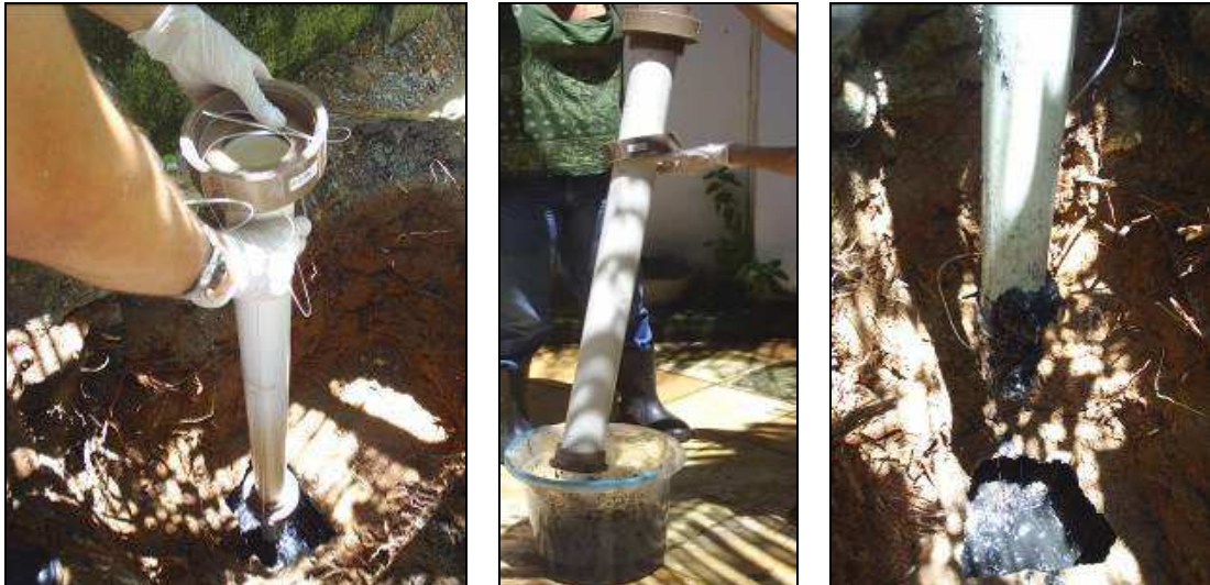
Figura 7: Utilização do amostrador de coluna em um tanque séptico
