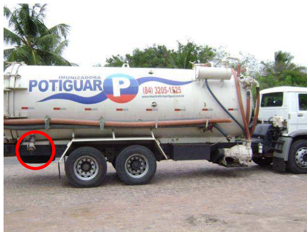
Figura 19: Caminhão limpa-fossa. Destaque para o ponto de saída de esgoto.
