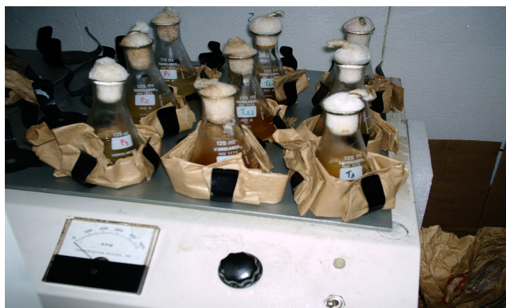
Figura 9 : Amostras das triplicas dos meios n° 1, 2 e 3 respectivamente, em Shaker a 30°C com agitação de 150 rpm.
