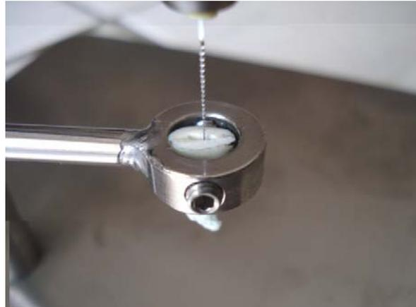
Figura 8 – Detalhes do anel em três dimensões com a lima de medição.
