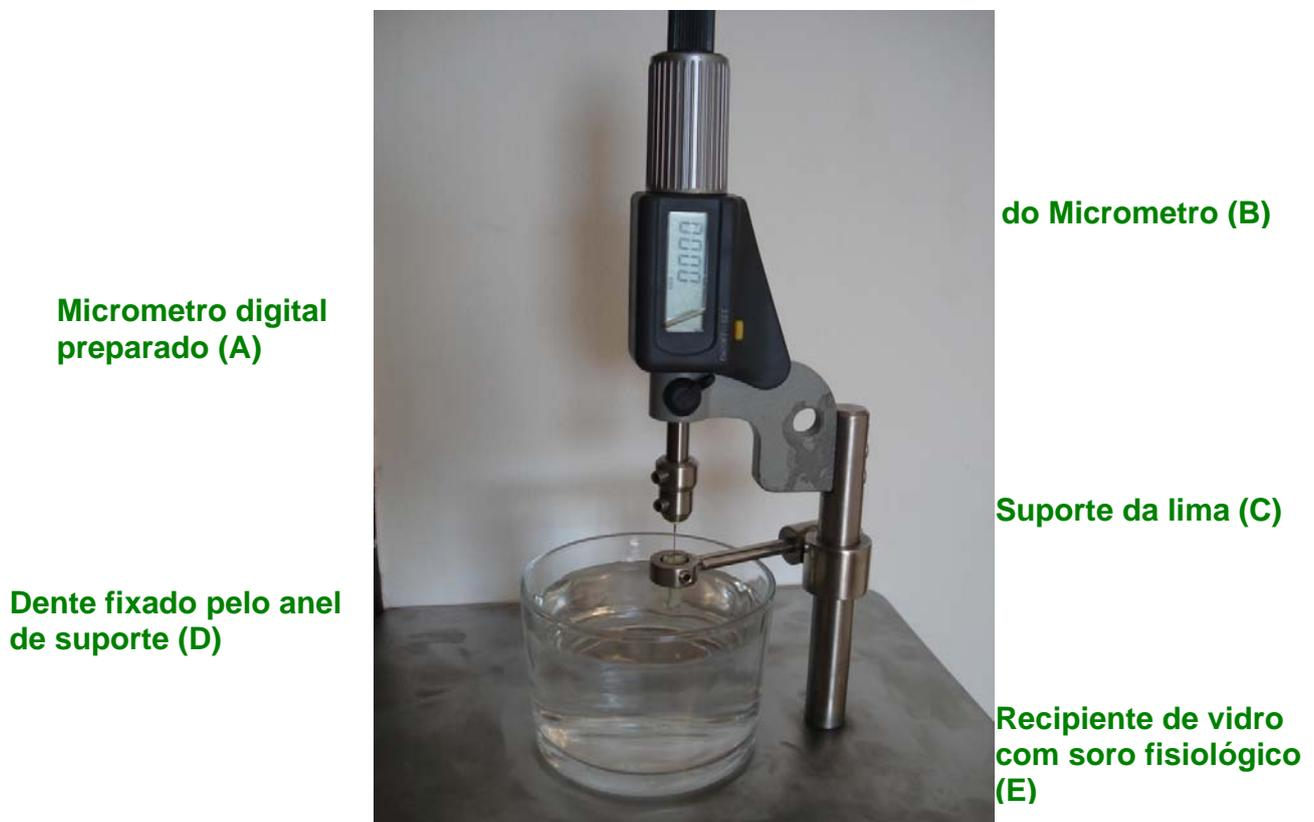
Figura 7 – Método da plataforma de medição modificado por D'Assunção e Albuquerque (2006), para avaliar a acurácia e repetibilidade de odontometrias eletrônicas.
