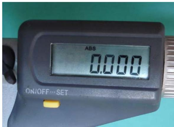
Figura 9 – Detalhes do medidor do micrômetro digital.
