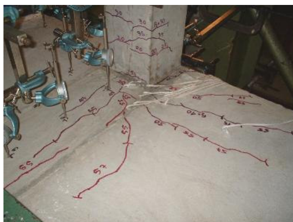
Primeiras fissuras L12
