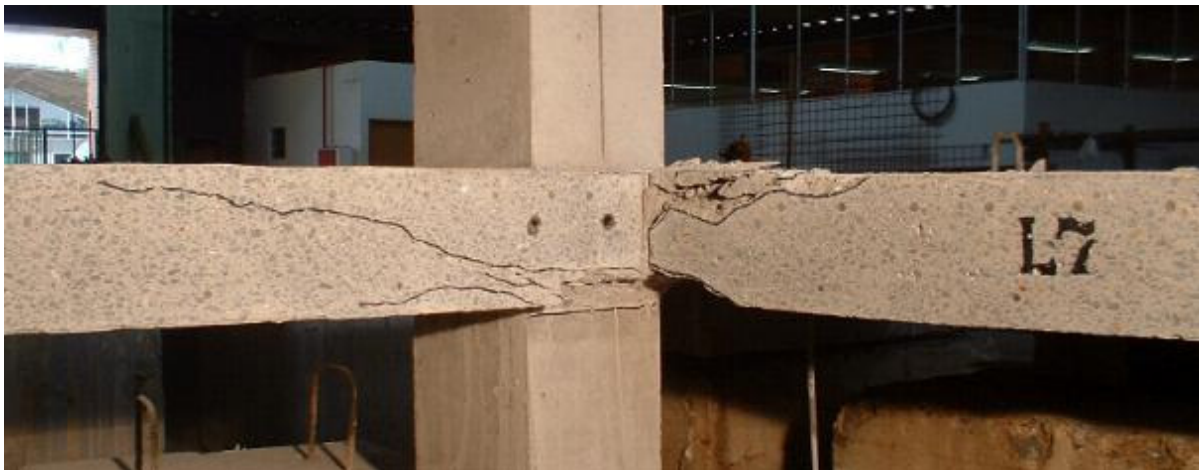
Figura 4.55 Seção transversal da ruptura laje L7
