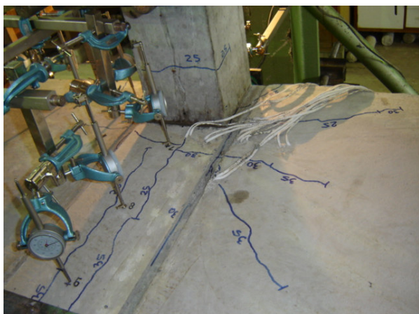
Primeiras fissuras L9
