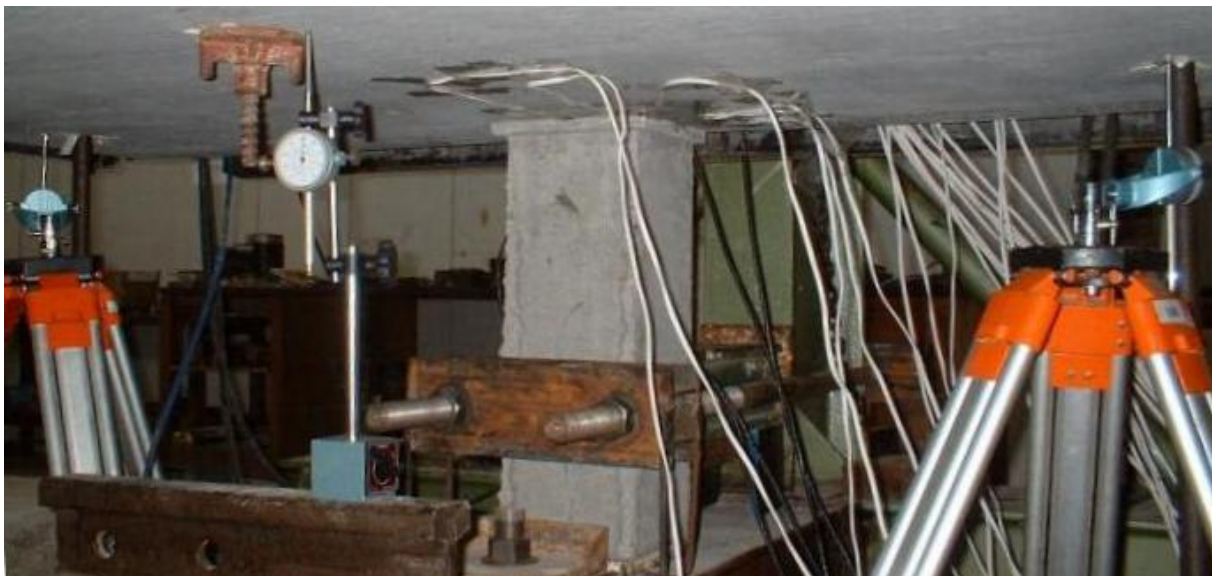
Figura 3.42 Relógios comparadores colocados sob a laje
