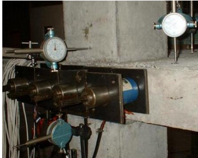
Relógios comparadores horizontais na superfície do pilar
