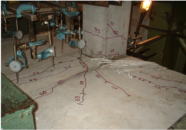
Primeiras fissuras L13
