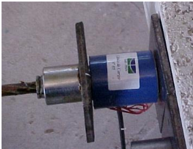
Figura 3.47 Célula de carga posicionada em ancoragem passiva de cabo de protensão
