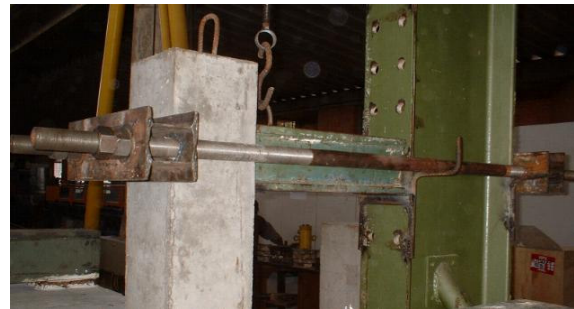
b) Fixação no pilar superior
