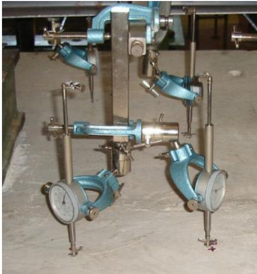
Relógios comparadores na superfície superior da laje
