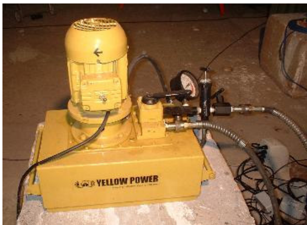
Bomba Hidráulica Elétrica (cargas P1 - macacos de 300 kN)
