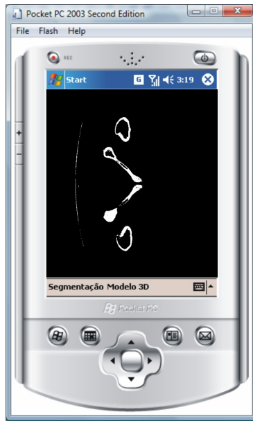
FIG. 4.17: Exemplo de segmentação utilizando a técnica de crescimento de região 3D.
