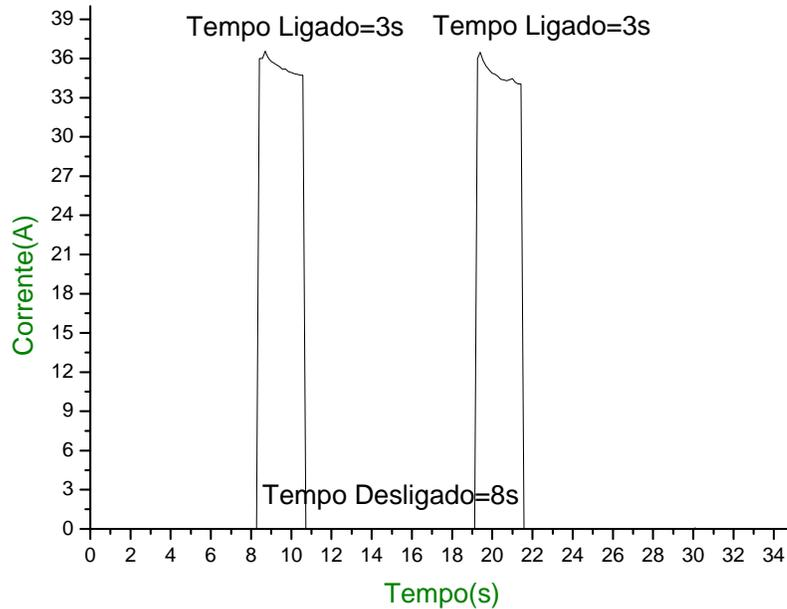
**Figura 4.10.b – Comportamento da corrente em função do tempo para uma vazão de  $0,623 \text{ m}^3/\text{h}$  de  $\text{H}_2$ .**
