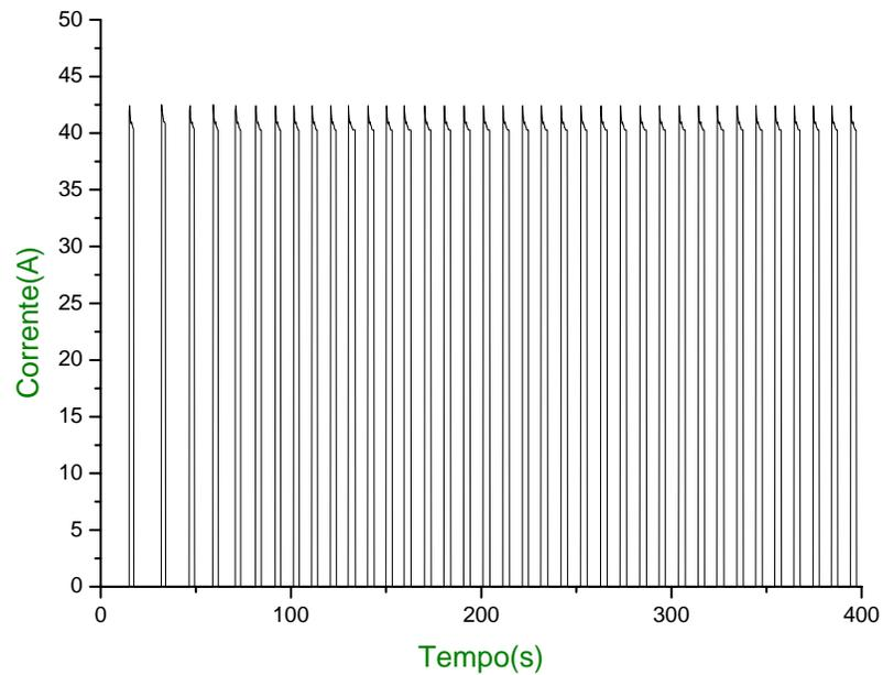
**Figura 4.11.a – Comportamento da corrente em função do tempo para uma vazão de 0,736 m<sup>3</sup>/h de H<sub>2</sub>**
