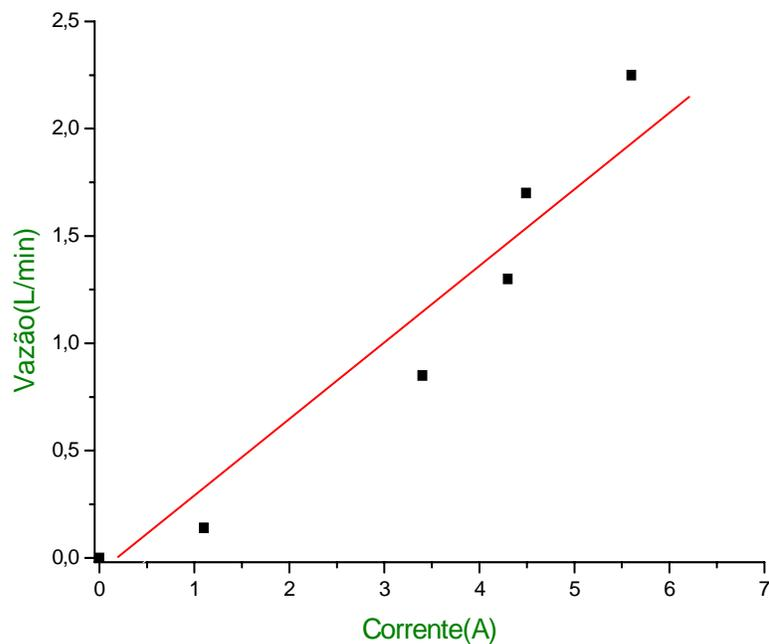
Figura 4.36 – Curva de calibração da vazão em função da corrente.
