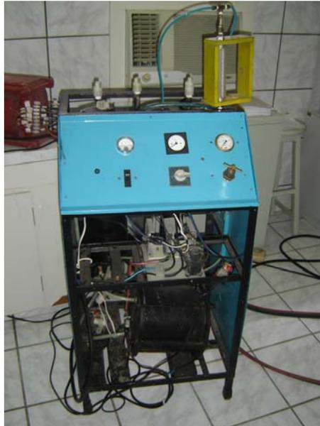
**Foto 3.1:** Eletrolisador Bipolar do LABDES.
