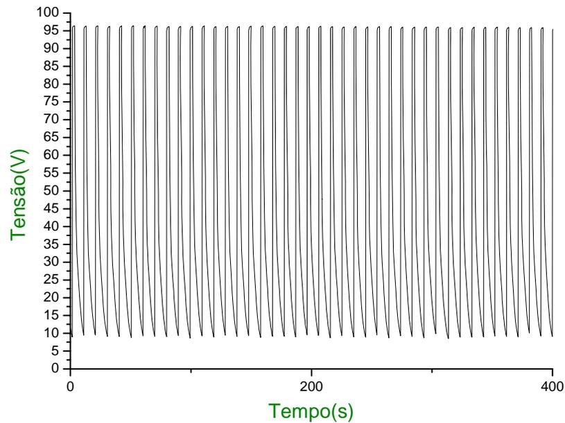
**Figura 4.20 – Comportamento da tensão do reator eletrolítico em função do tempo para uma vazão de  $0,91 \text{ m}^3/\text{h}$  de  $\text{H}_2$ .**
