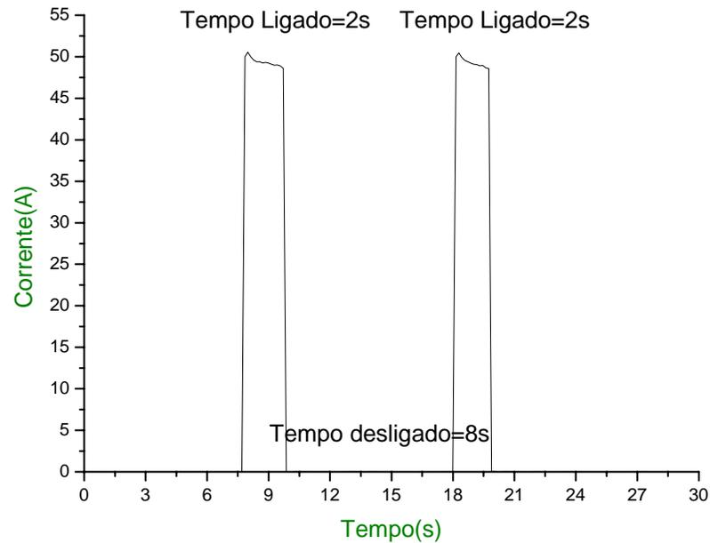
**Figura 4.13.b – Comportamento da corrente em função do tempo para uma vazão de 0,91 m<sup>3</sup>/h de H<sub>2</sub>.**
