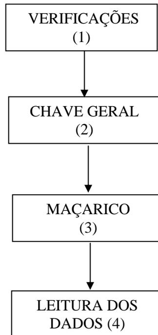
1) PROCEDIMENTO – Observar os níveis de água, benzina e álcool, verificar se há algum tipo de vazamento e se o maçarico está fechado;
