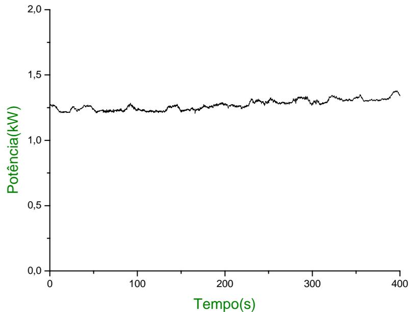
**Figura 4.21 – Comportamento da potência do reator eletrolítico em função do tempo para uma vazão de 0,22 m<sup>3</sup>/h de H<sub>2</sub>.**
