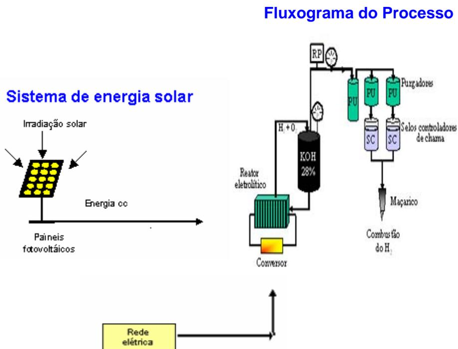
**Figura 3.1:** Fluxograma do Processo Eletrolítico (Pereira, 2005).
