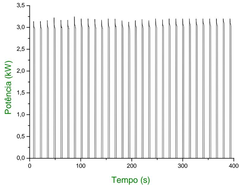
**Figura 4.24 – Comportamento da potência do reator eletrolítico em função do tempo para uma vazão de  $0,568 \text{ m}^3/\text{h}$  de  $\text{H}_2$ .**
