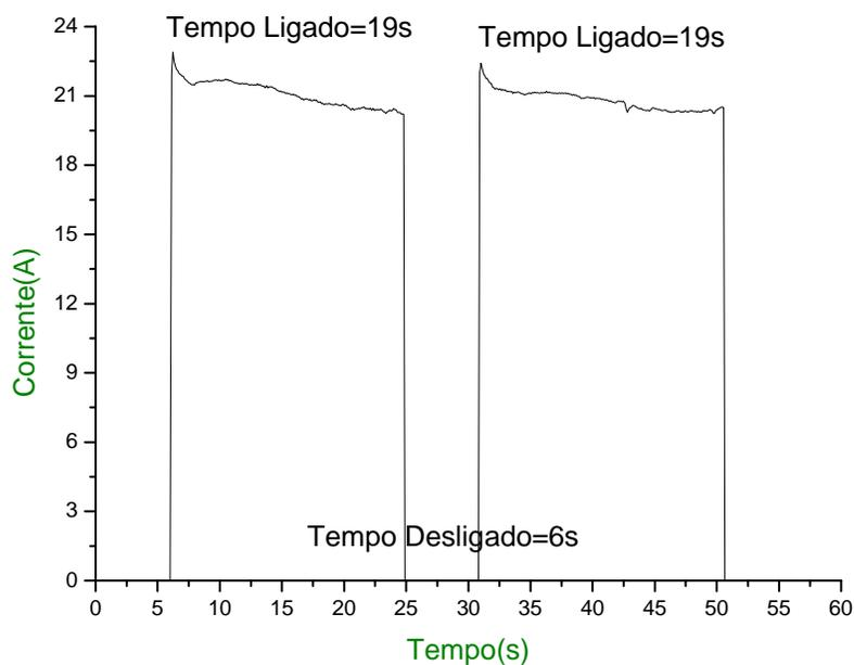
**Figura 4.7.b – Comportamento da corrente em função do tempo para uma vazão de 0,35 m<sup>3</sup>/h.**
