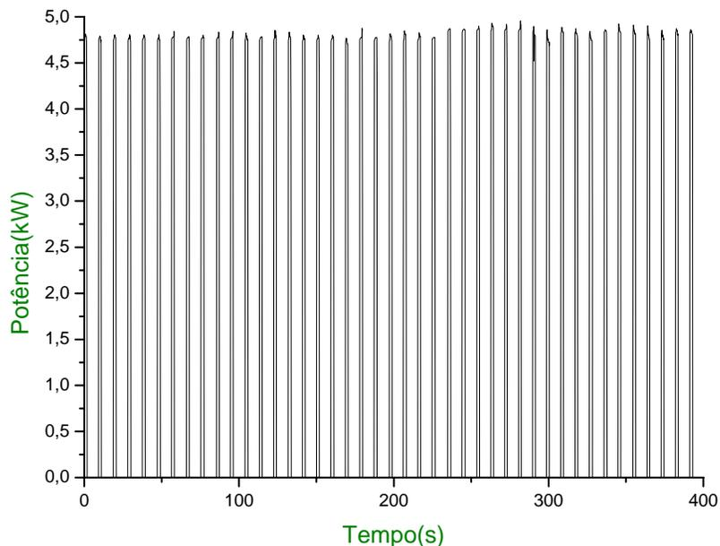
**Figura 4.28 – Comportamento da potência do reator eletrolítico em função do tempo para uma vazão de 0,91 m<sup>3</sup>/h de H<sub>2</sub>.**
