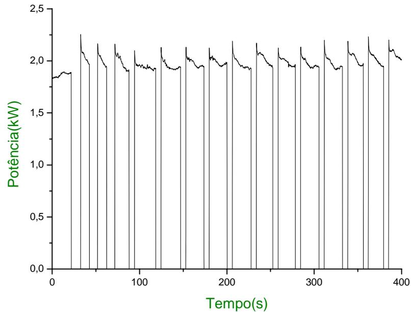
**Figura 4.22 – Comportamento da potência do reator eletrolítico em função do tempo para uma vazão de 0,35 m<sup>3</sup>/h de H<sub>2</sub>.**
