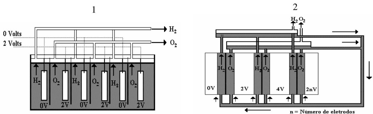
**Figura 2.2 - 1) Configuração unipolar e 2) configuração bipolar do eletrolisador (Pereira, 2005).**
