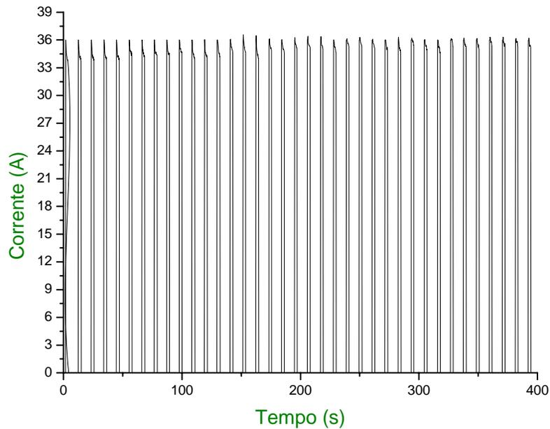
**Figura 4.10.a – Comportamento da corrente em função do tempo para uma vazão de 0,623 m<sup>3</sup>/h de H<sub>2</sub>.**
