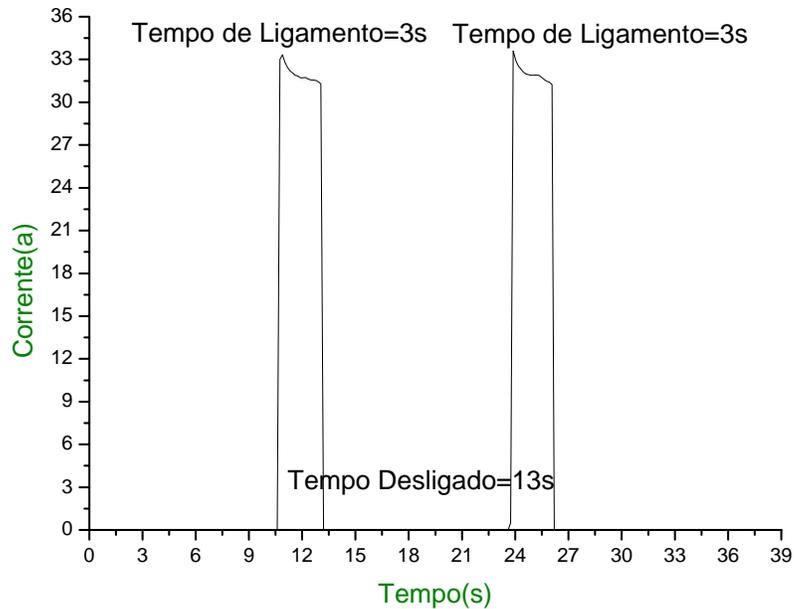
**Figura 4.9.b – Comportamento da corrente em função do tempo para uma vazão de 0,568 m<sup>3</sup>/h de H<sub>2</sub>.**
