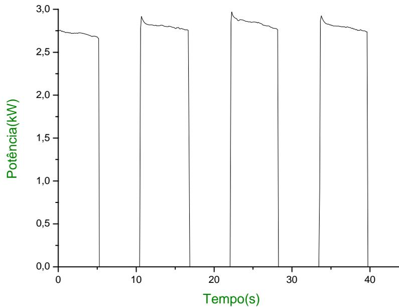
**Figura 4.4: Comportamento da potência em função do tempo.**
