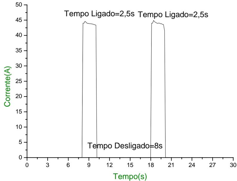
**Figura 4.12.b – Comportamento da corrente em função do tempo para uma vazão de  $0,763 \text{ m}^3/\text{h}$  de  $\text{H}_2$ .**
