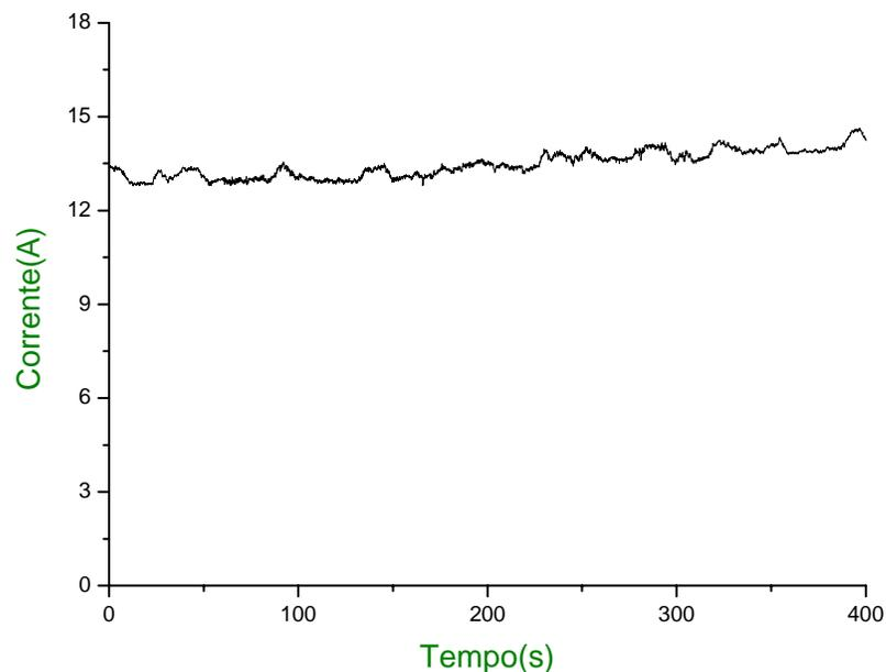
**Figura 4.6 – Comportamento da corrente em função do tempo para uma vazão de  $0,22 \text{ m}^3/\text{h}$  de  $\text{H}_2$ .**
