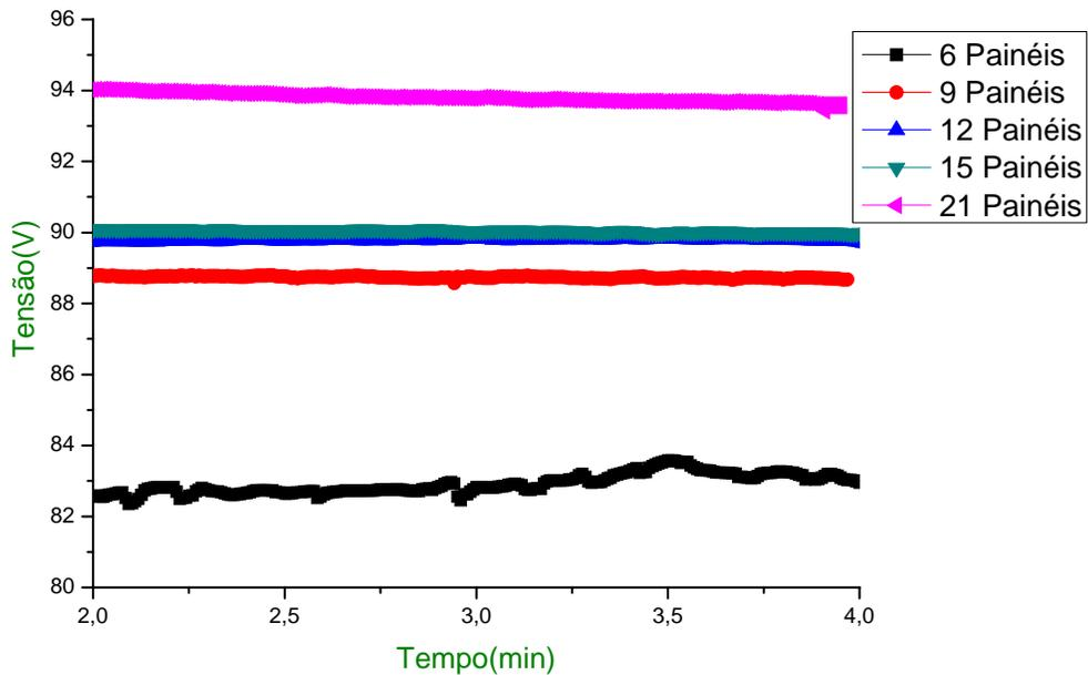
**Figura 4.33 – Comportamento da tensão do reator eletrolítico em função do tempo para diversas configuração de painéis solares em série.**
