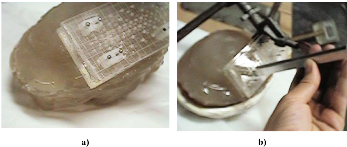
Figura 6.11: Descrição do implante de sementes de 0,8 mm x 4 mm de Sm-152 em fantoma físico. Suporte de acrílico para distribuição dos segmentos (a). Fontes deixadas na massa tumoral e colocas uniformemente (b).
