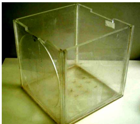
Figura 4.2: Simulador geométrico (20 x 20 x 40) cm 3 . Fonte: VIEGAS, 2003
