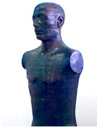
Figura 4.3: Simulador antropomórfico RANDO-Alderson. Fonte: VIEGAS, 2003.
