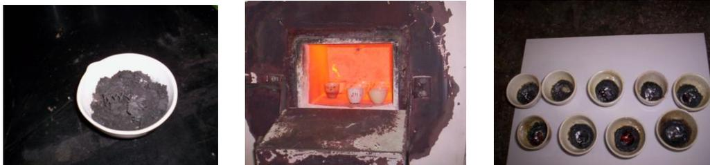
Figura 12 – Seqüência da simulação do processo de redução do chumbo em laboratório.
