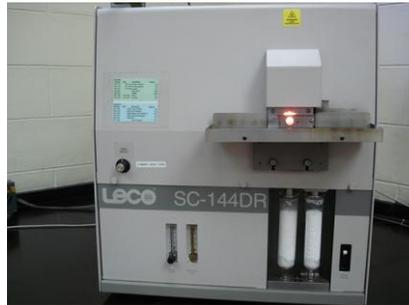
Figura 8 – Equipamento utilizado para análise de enxofre: LECO
