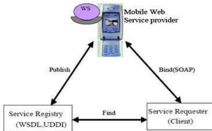
Figura 3.6: Configuração Básica de um Mobile Host, extraído de (Srirama 2006b)
