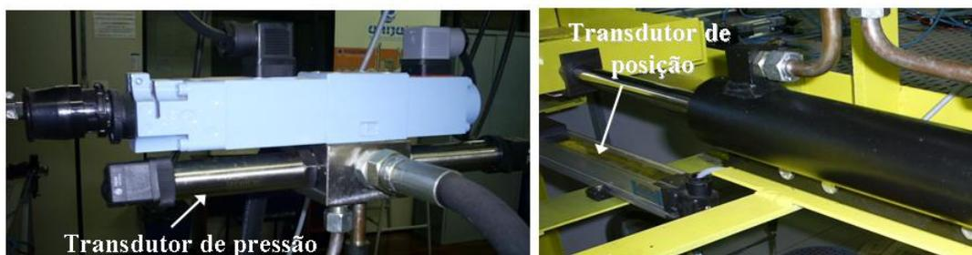
Figura 19 – Esquema fotográfico dos transdutores de pressão e posição
