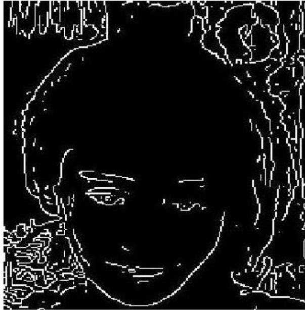
Figura 5.5: Detecção usando método de Canny dobrando a amostragem.
