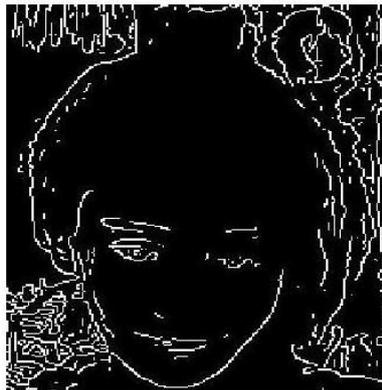
Figura 5.4: Detecção usando método de Canny dobrando a amostragem.
