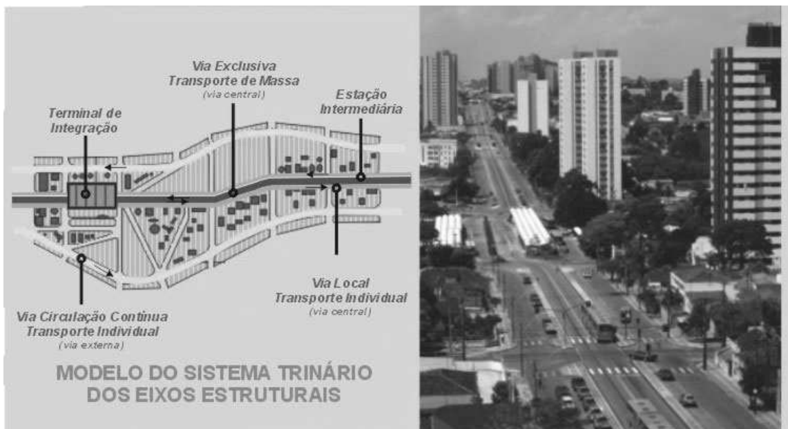
Figura 8: Modelo do sistema trinário dos eixos estruturais
