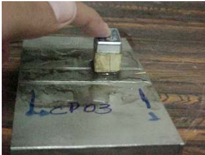
Figura 54; Realização do ensaio de ultra-som com o cabeçote de 60°
