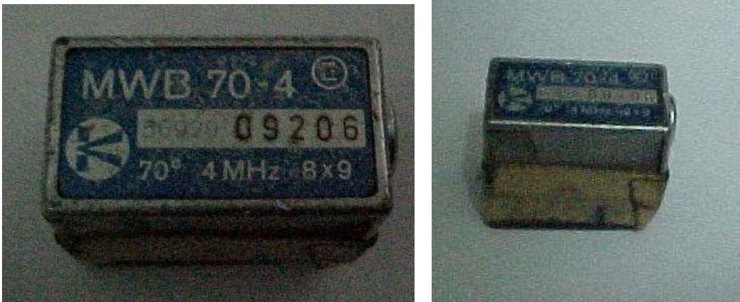
Figuras 37 e 38 - Cabeçote Angular Krautkramer de 70° de 4 MHz – Numero de Série 36920 09206. Vista Superior e Frontal
