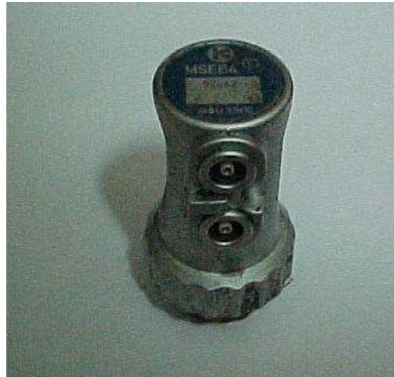
Figuras 31 e 32 - Cabeçote Duplo Cristal Krautkramer de 4 MHz – Numero de Série 57462 1594. Vista Superior e Frontal
