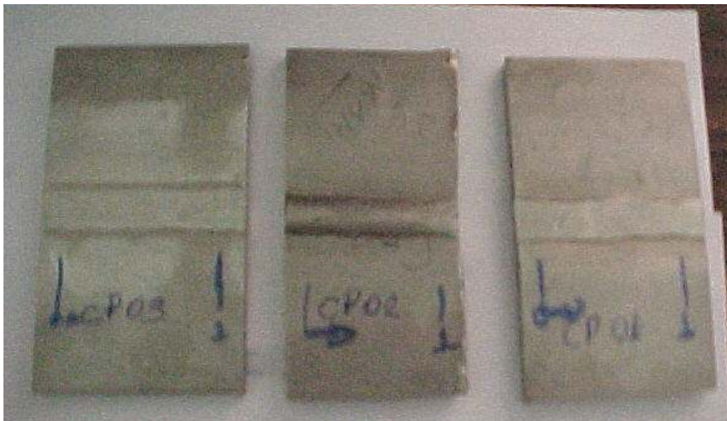
Figura 60 - Marcação realizada nos corpos de prova para facilitar a localização de possíveis defeitos
