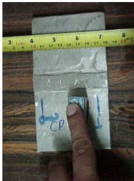
Figura 57 - Realização do ensaio de ultra-som com o cabeçote de 70°
