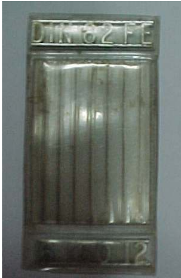
Figura 42 - Modelo de Indicador de qualidade de imagem utilizado na gamagrafia industrial.
