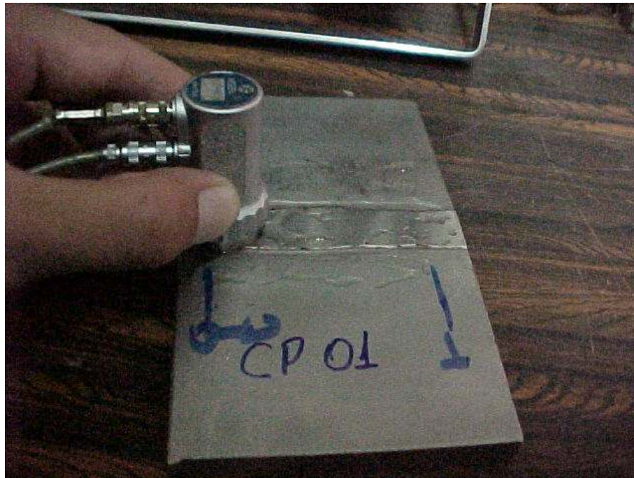
Figura 49: Realização do ensaio de ultra-som utilizando o cabeçote duplo-cristal com frequência de 4 MHz com movimentação sobre o reforço da solda.
