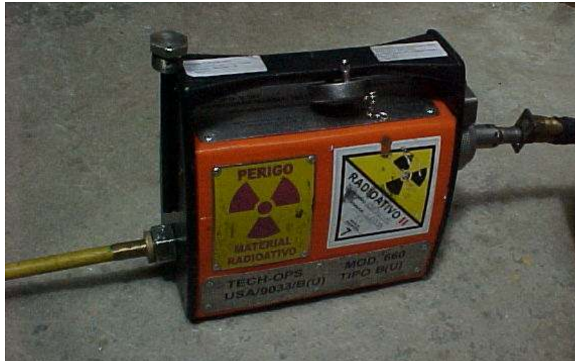
Figura 15: Irradiador de uma fonte radioativa de Iridio 192
