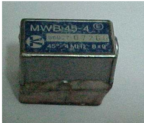
Figuras 33 e 34 - Cabeçote Angular Krautkramer de 45° de 4 MHz – Numero de Série 56907 07266. Vista Superior e Frontal
