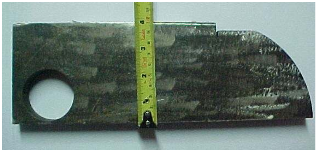
Figura 25: Bloco V1 – Fabricado conforme requisitos dimensionais estabelecidos no código ASME V
