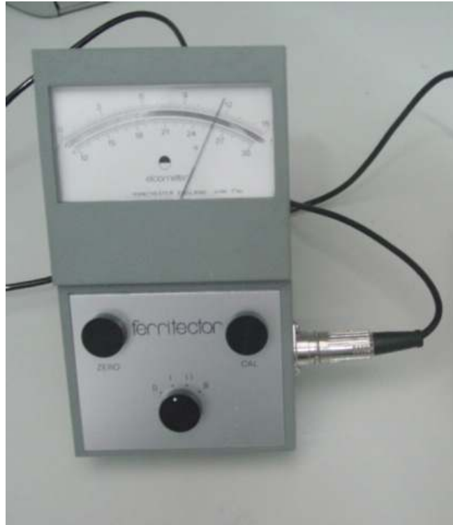
Figura 40: Ferritoscópio Ecolmeter utilizado para medição da ferrita delta
