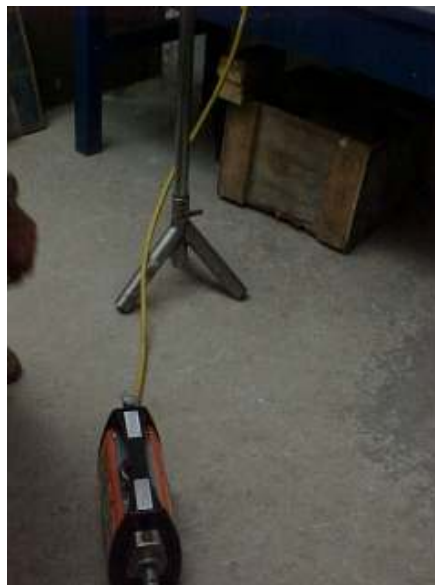
Figura 16 - Tubo Guia – Responsável por direcionar a fonte ao local da exposição
