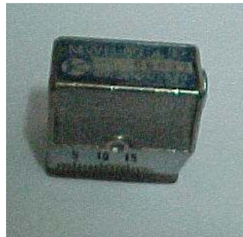
Figuras 35 e 36 - Cabeçote Angular Krautkramer de 60° de 4 MHz – Numero de Série 06092. Vista Superior e Frontal
