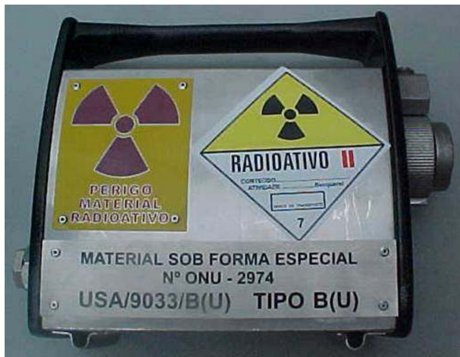
Figura 41 - Aspecto do irradiador utilizado para execução do ensaio de gamagrafia nos corpos de prova.
