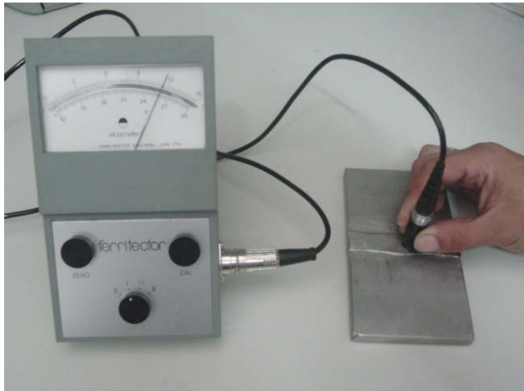
Figura 43: Realização da medição de ferrita delta ao longo do corpo de prova
