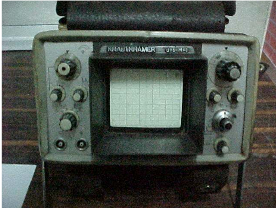
Figura 29 - Aparelho de ultra-som marca Krautkramer – Modelo: USM II
