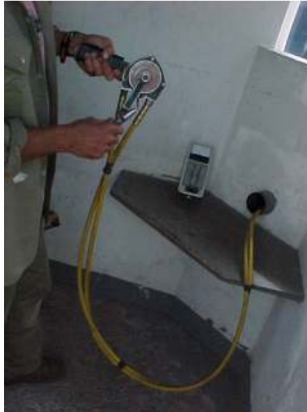
Figura 17 - Cabo de comando – Responsável por expor a fonte de radiação
