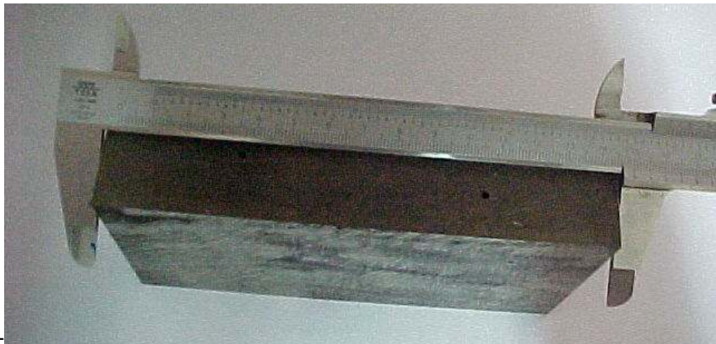
Figuras 26 e 27 - Aspecto geral do Bloco de referência utilizado para determinação das curvas de referência para cada tipo de cabeçote utilizado – Dimensões contidas no Procedimento de ultra som – item 9
