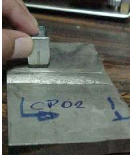
Figura 51: Realização do ensaio de ultra-som no corpo de prova 01 com a utilização do cabeçote de 45° Modelo MWB 45-4. Movimentação do cabeçote sobre o metal de base
