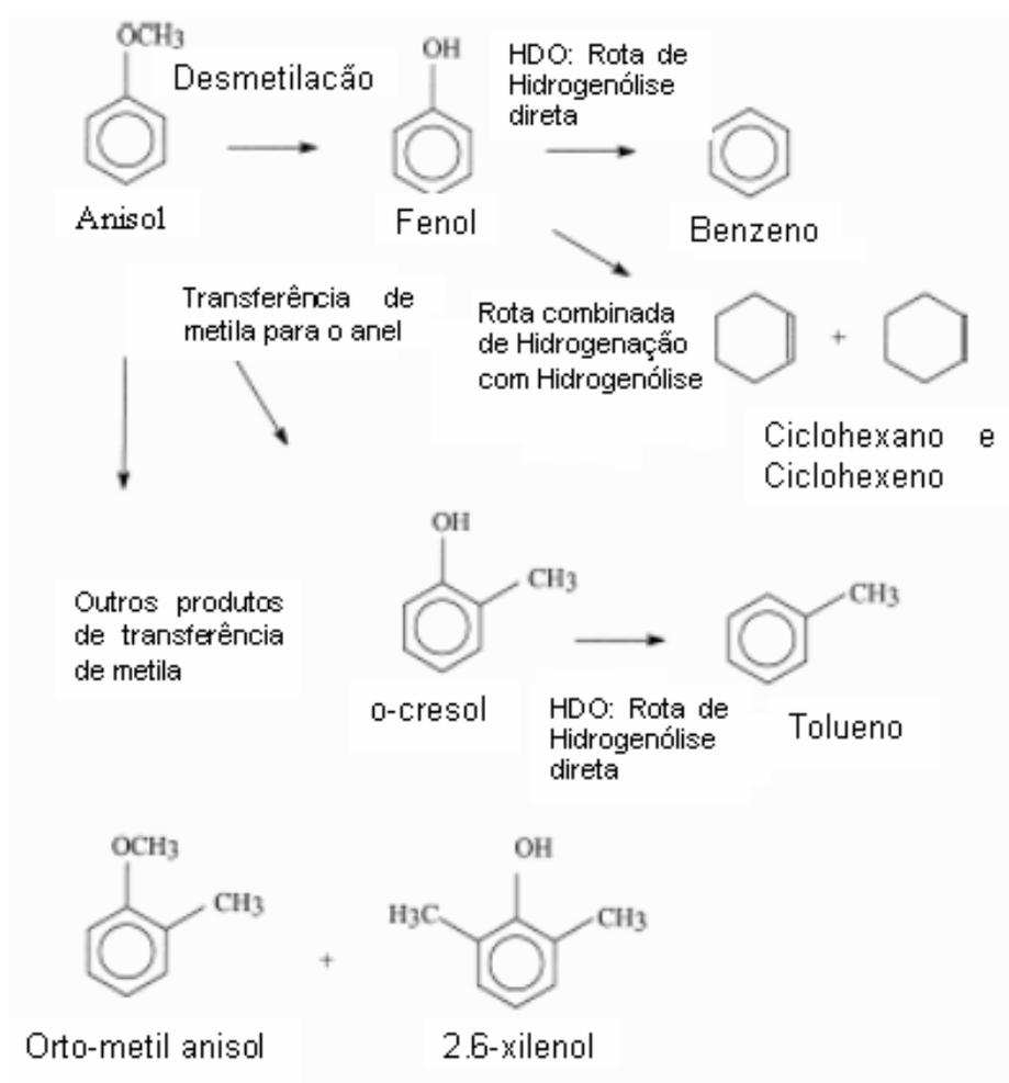
**FIGURA 2.20:** Esquema simplificado das possíveis rotas de HDO do anisol (VILJAVA e col., 2000).
