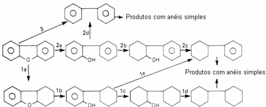
**FIGURA 2.23:** Esquema reacional da Hidrodeoxigenação do dibenzofurano (LaVopa e Satterfield, 1987).
