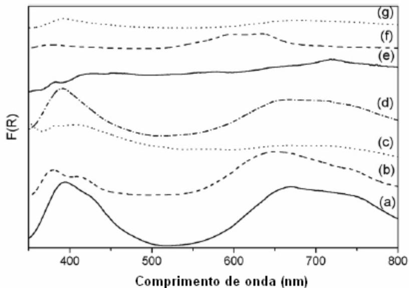
**FIGURA 2.2:** Espectro de DRS do catalisador  $Ni/Al_2O_3$  preparado por (a) impregnação seca; (b) por co-precipitação (c) após calcinação; (d) mistura mecânica de  $Ni(NO_3)_2$ ; e  $Al_2O_3$ ; (e)  $NiO$ ; (f)  $NiAlO_4$  e (g)  $Ni(OH)_2$  (SAVVA e col., 2008).
