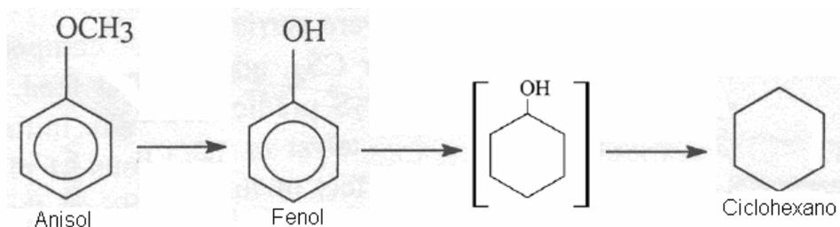
**FIGURA 5.21:** Rota de hidrogenação combinada com hidrogenólise
