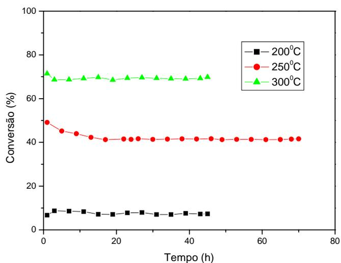
**FIGURA 5.17:** Testes de longa duração do catalisador NiMoAl sulfetado realizados a 200°C, 250°C e 300°C e pressão de 15 kgf/cm<sup>2</sup>
