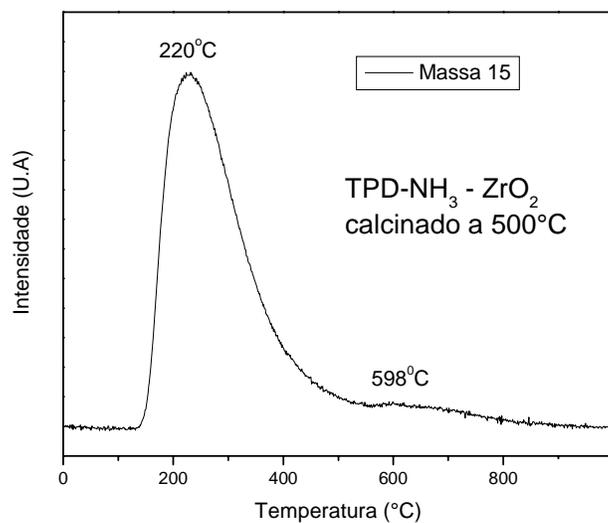
**FIGURA 5.11:** Perfil de dessorção de NH<sub>3</sub> do suporte zircônia calcinado a 500°C.
