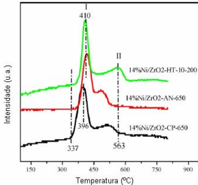
**FIGURA 2.8:** Perfil de TPR do catalisador 14% Ni/ZrO<sub>2</sub> com o suporte preparado por diferentes métodos (SONG e col., 2008)
