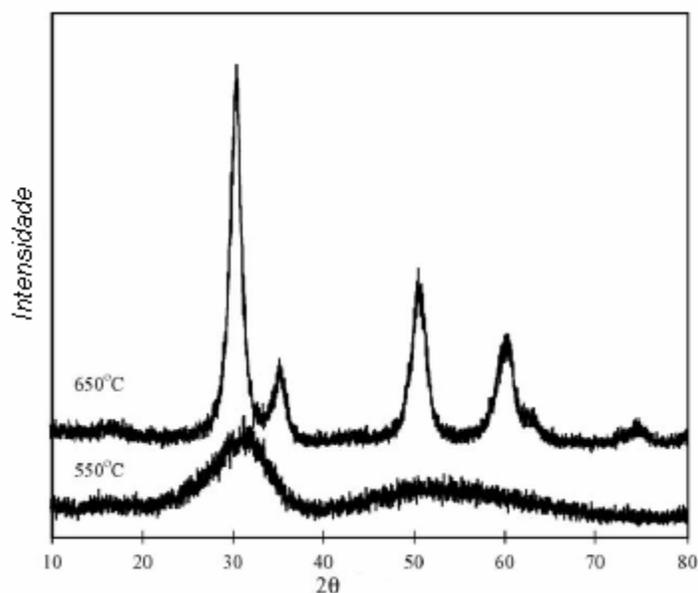
**FIGURA 2.9:** Difratogramas de Raios X para a ZrO<sub>2</sub> calcinada em diferentes temperaturas
