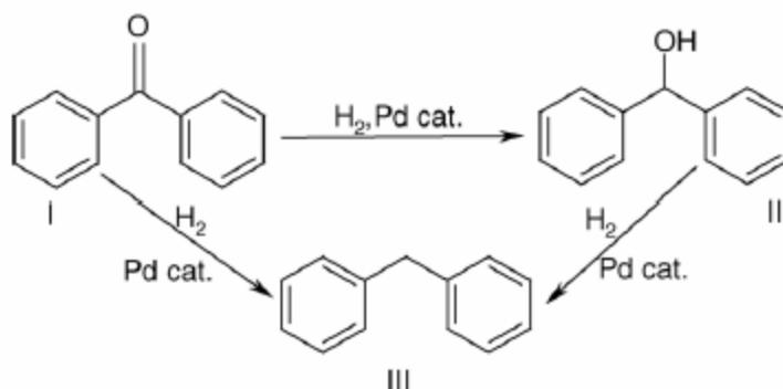
**FIGURA 2.25:** Esquema reacional da benzofenona em catalisadores de Pd suportados
