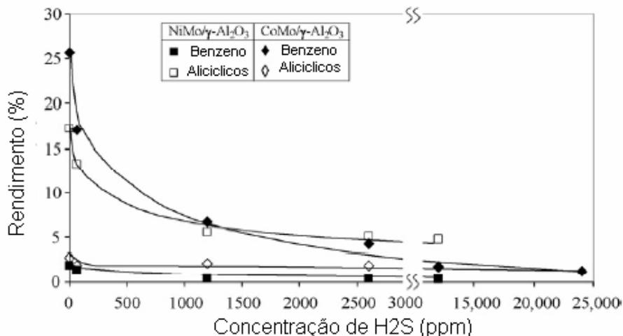
**FIGURA 2.29:** Efeito da concentração de H<sub>2</sub>S no rendimento de benzeno e hidrocarbonetos alifáticos na reação de HDO do fenol em catalisadores sulfetados a 250°C e 1,5 MPa. (SENOL e col., 2007)
