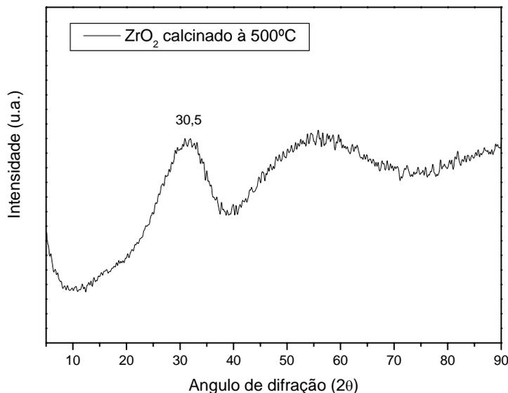
**FIGURA 5.3** – *Difratograma de Raios X do ZrO<sub>2</sub> calcinado a 500°C*
