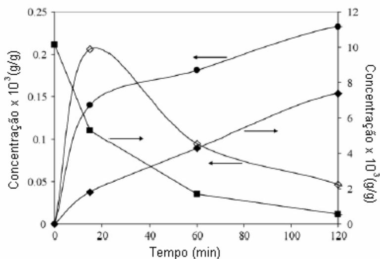
**FIGURA 2.19:** Perfis de concentração de (■) fenol, (●) benzeno, (▲) ciclohexano, e (◊) ciclohexeno em ausência de H<sub>2</sub>S à 250°C e 7,5 MPa de pressão com catalisador de Ni-Mo/Al<sub>2</sub>O<sub>3</sub>. (SENOL e colaboradores, 2007).
