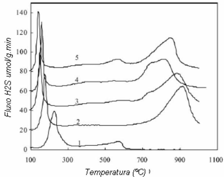
**FIGURA 2.10:** Espectros de TPR dos catalisadores sulfetados: (1) Ni/Zr(650); (2) Mo/Zr(650); (3) Ni-Mo/Zr(550) antes da calcinação; (4) Ni-Mo/Zr(550) após a calcinação; (5) Ni-Mo/Zr(650). (JIA e col, 2005)
