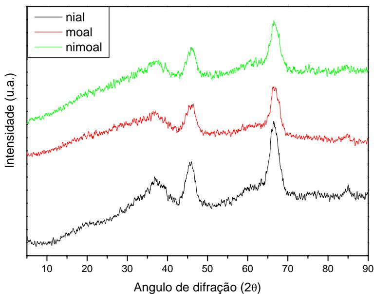
**FIGURA 5.2** – *Difratograma de Raios X dos catalisadores suportados em alumina.*
