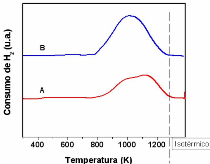
**FIGURA 2.4:** Perfis de TPR dos catalisadores (A) 8% Ni/ $\gamma$ -Al<sub>2</sub>O<sub>3</sub> e (B) 16% Ni/ $\gamma$ -Al<sub>2</sub>O<sub>3</sub>.
