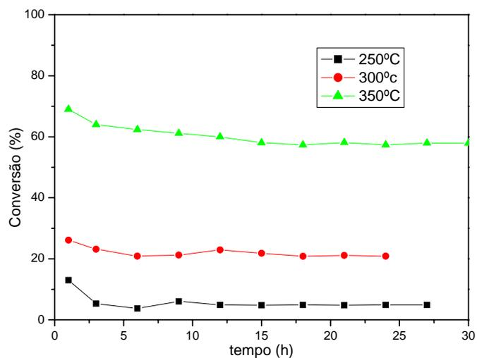
**FIGURA 5.18:** *Teste de longa duração do catalisador NiMoZr sulfetado realizados a 250°C, 300°C e 350°C e pressão de 15 kgf/cm<sup>2</sup>.*
