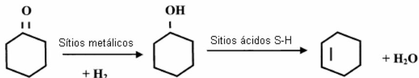
**FIGURA 2.24:** Esquema reacional da HDO da ciclohexanona (Olivas e col., 2001)
