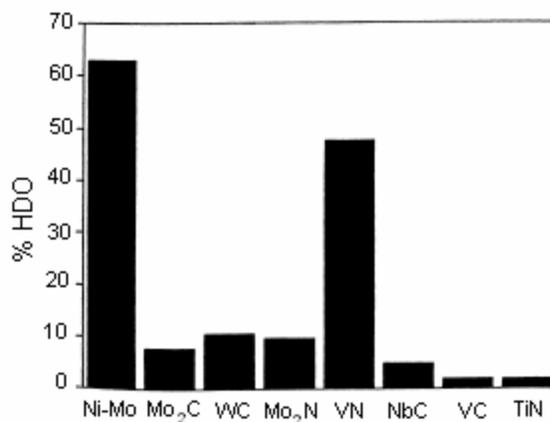
**FIGURA 2.17:** Comparação entre catalisadores utilizados na reação de HDO do benzofurano. (RAMANATHAN e OYAMA, 1995)
