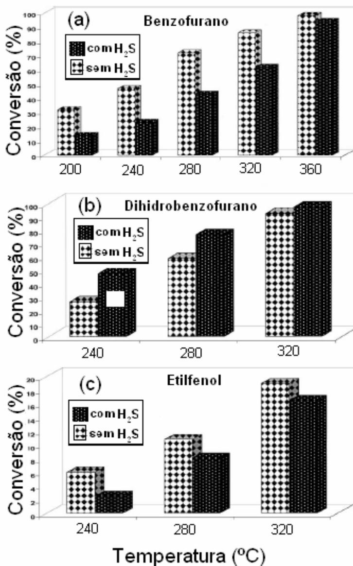
**FIGURA 2.30:** Efeito da sulfetação sobre a conversão, nas reações do benzofurano (a) e dos intermediários dihidrobenzofurano (b) e etilfenol (c) (BUNCH & OZKAN, 2002).
