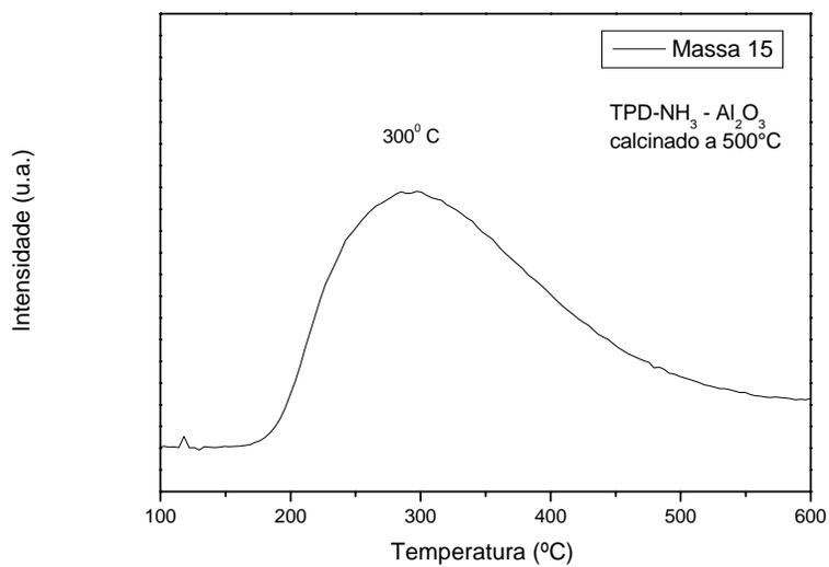
**FIGURA 5.12:** Perfil de dessorção de NH<sub>3</sub> do suporte alumina calcinado a 500°C
