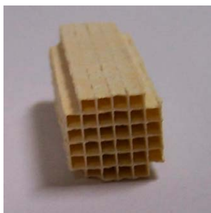
Figura 5.2: Estrutura monolítica cerâmica recoberta com \gamma -Al 2 O 3 : detalhe dos canais.
